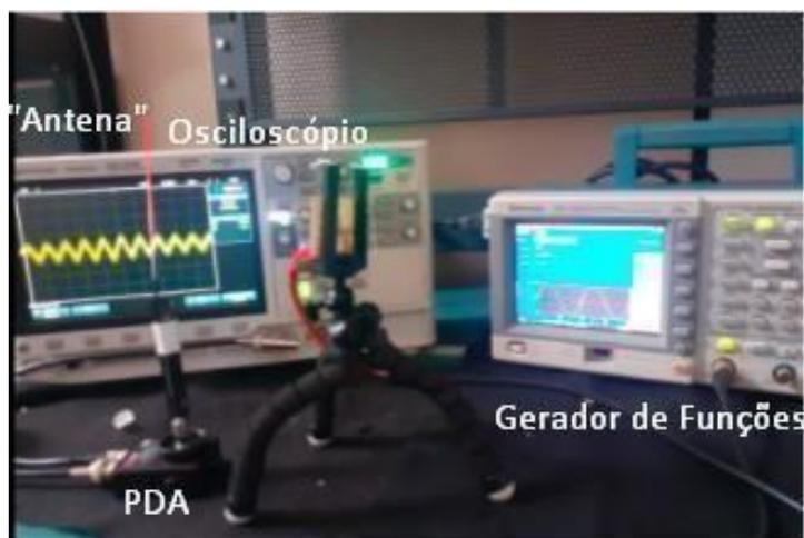
Figura 47 - Montagem em laboratório mostrando gerador de funções, osciloscópio, PDA10 e “antena-óptica”.
