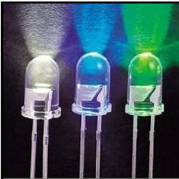
Figura 9: LEDs de Alto Brilho com Encapsulamento Hemisférico transparente emitindo branco, azul e verde.[16]
