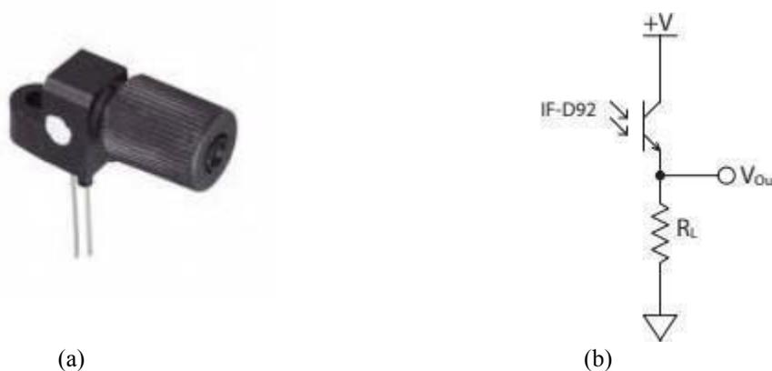
Figura 21 -(a) Fototransistor IF-D92 (b)Esquema de circuito de polarização IF-D92 [45]
