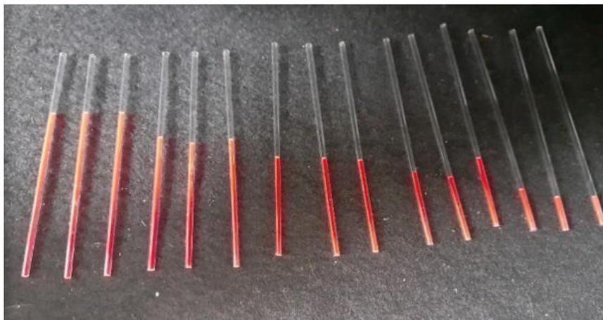
Figura 34 - “Antenas” ópticas fluorescentes encapsuladas no capilar de vidro, de vários tamanhos.
