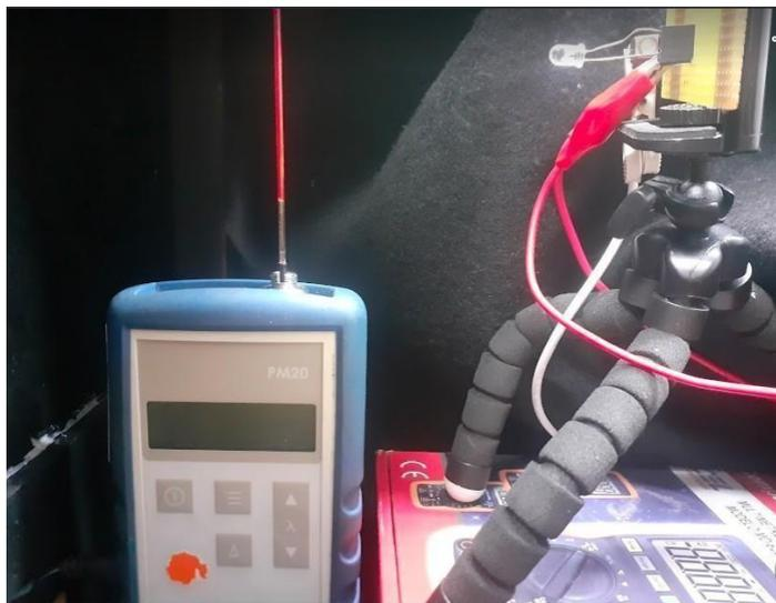
Figura 43 Um *zoom* na foto montagem experimental momentaneamente configurada para enlaces muito curtos . focando na “antena óptica” sem encapsulamento conectada diretamente no MPO e a fonte de luz.
