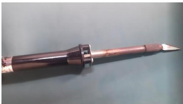
Figura 37 - Ferro de soldar com lâmina na extremidade utilizado para imprimir ranhuras superficiais “a frio” ou a “quente” na “POF-antena”
