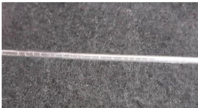
Figura 38 Foto de uma POF PMMA com ranhuras superficiais impressas à frio.
