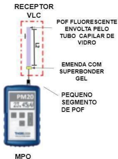
Figura 40 (a) Fotos do Superbonder Gel, capilar de vidro e "antena" de POF fluorescente, (b) Esquema da segunda melhoria quanto a interface com a antena óptica visando reduzir perda de inserção.
