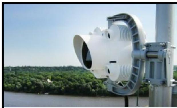
Figura 12: Equipamento para Enlace FSO baseado em Laser [23]
