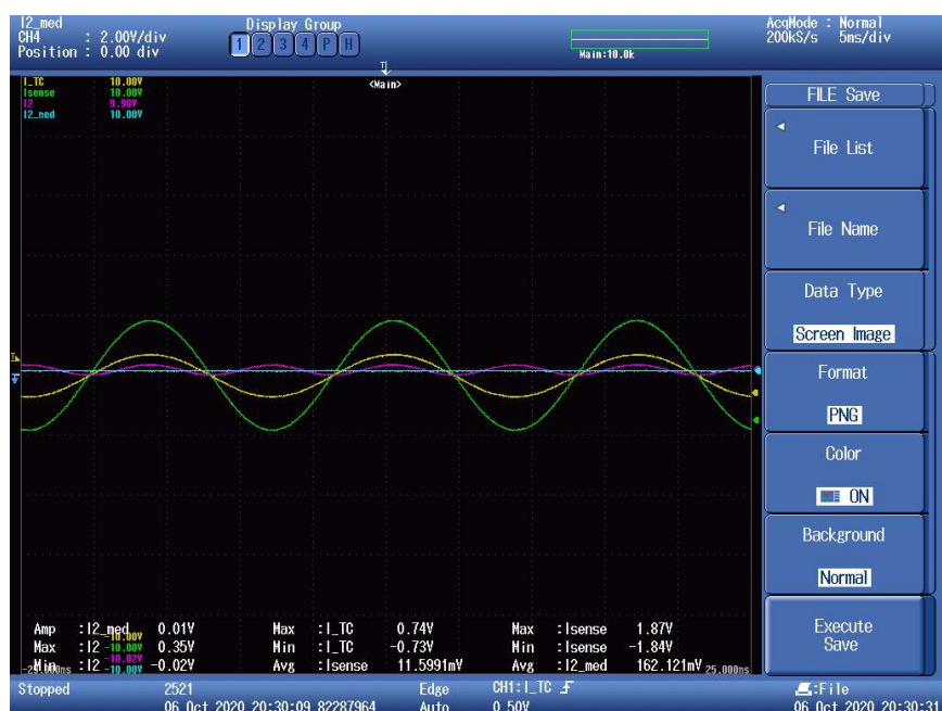
Figura 71 – Formas de onda obtidas no ensaio de corrente de 5 A
