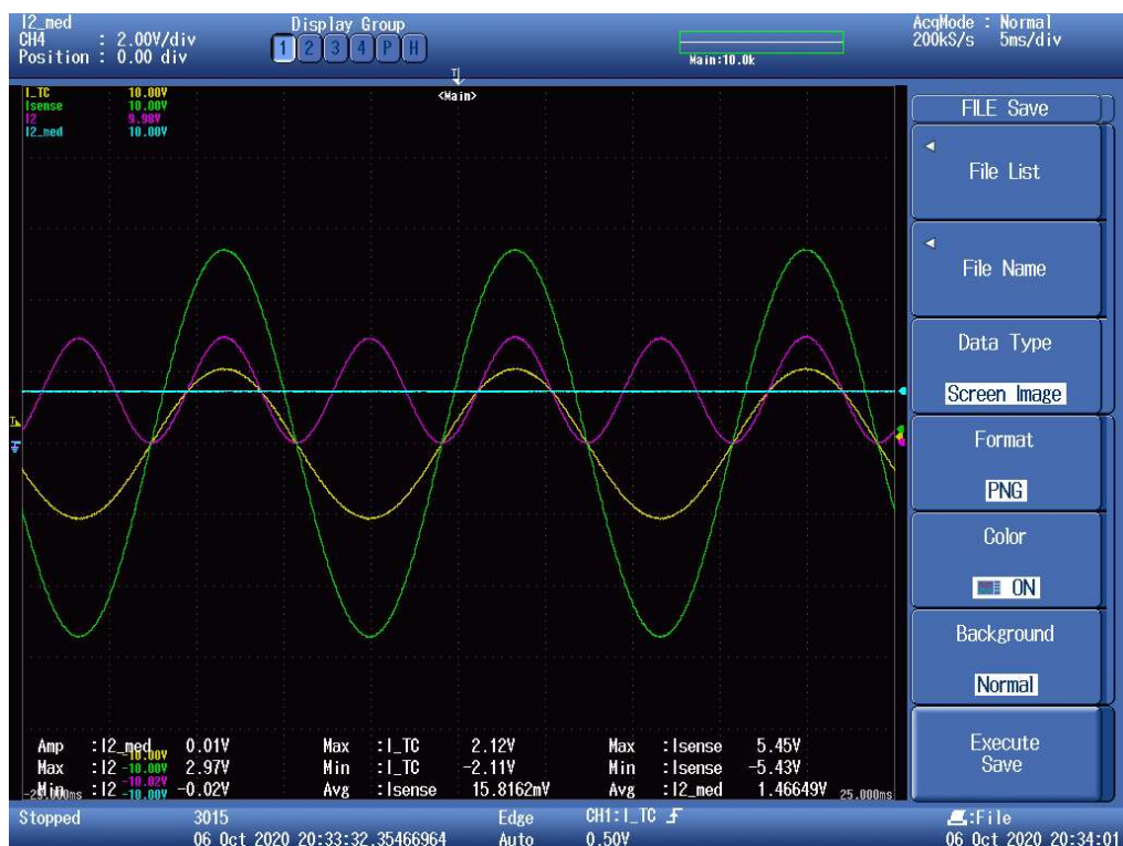
Figura 73 – Formas de onda obtidas no ensaio de corrente de 15 A
