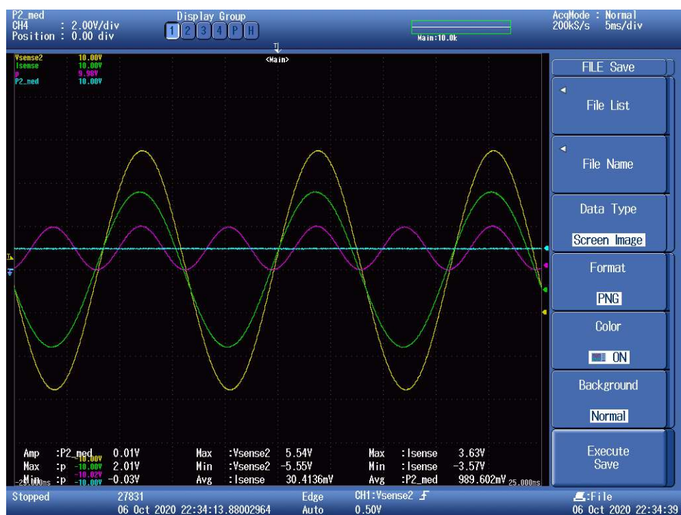
Figura 76 – Formas de onda obtidas no ensaio de potência de 1500 w
