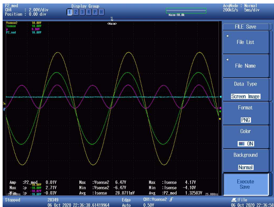
Figura 77 – Formas de onda obtidas no ensaio de potência de 2000 w
