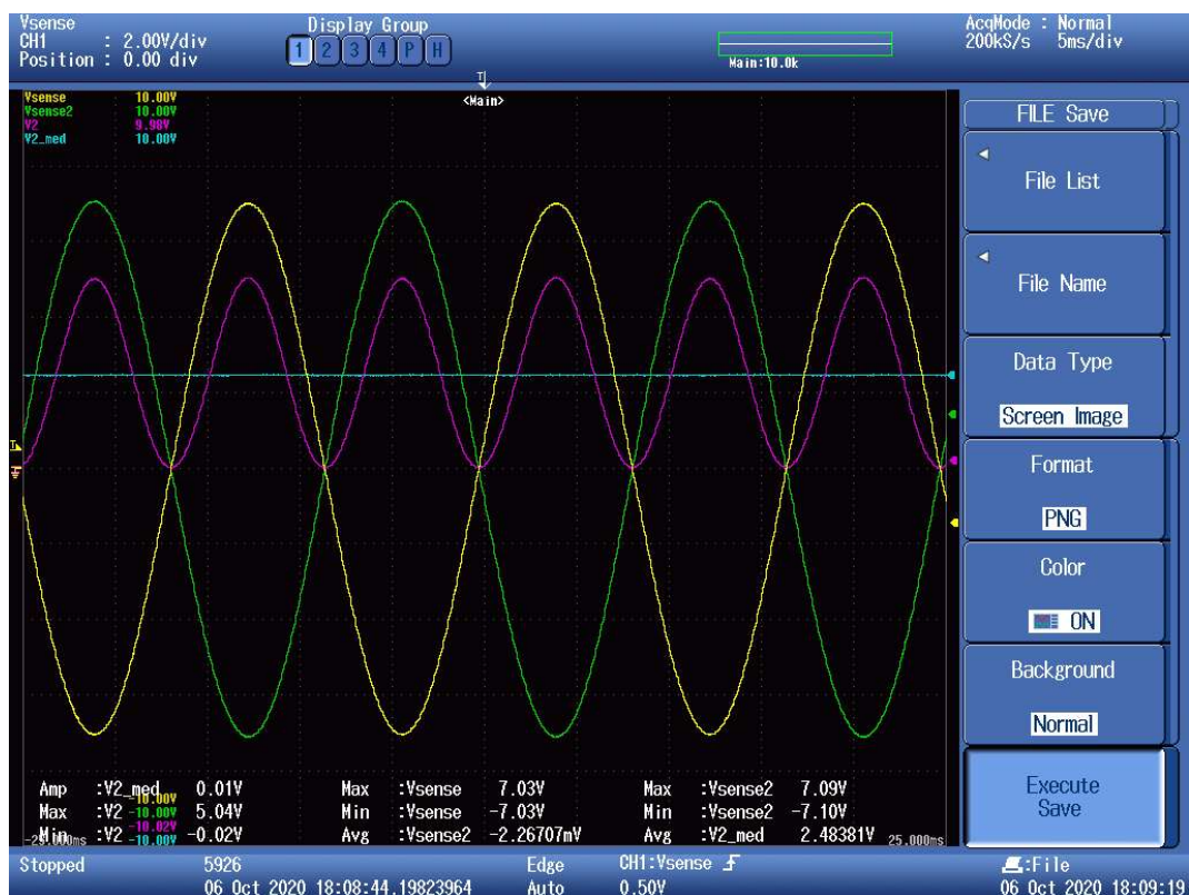
Figura 69 – Formas de onda obtidas no ensaio de tensão de 190 V
