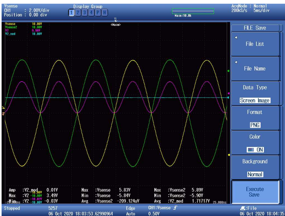
Figura 66 – Formas de onda obtidas no ensaio de tensão de 160 V
