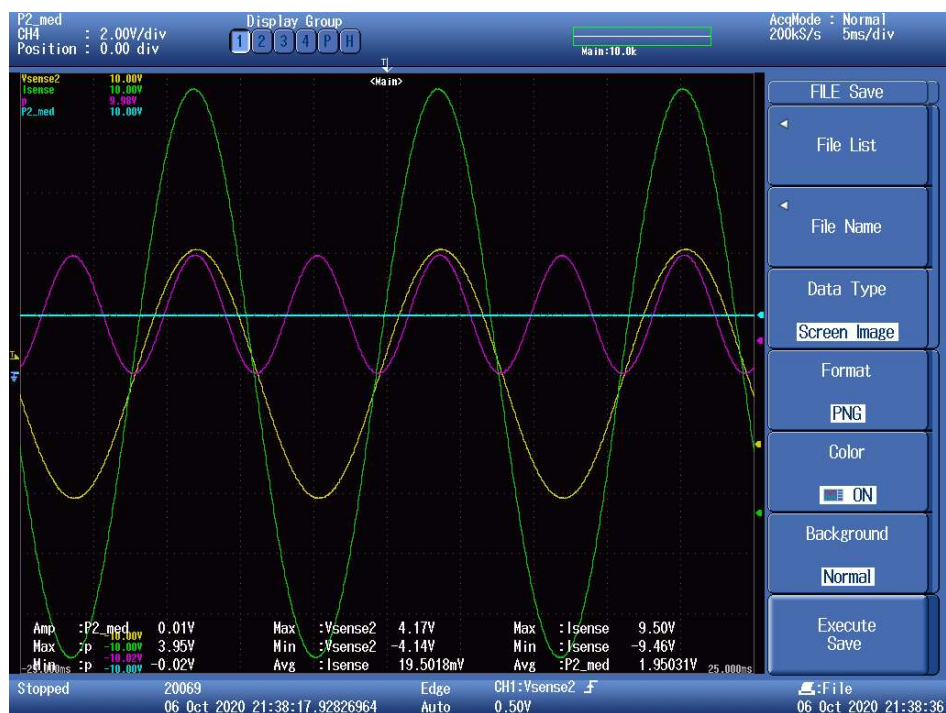
Figura 79 – Formas de onda obtidas no ensaio de potência de 3000 w
