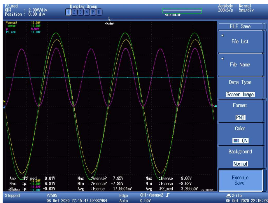
Figura 83 – Formas de onda obtidas no ensaio de potência de 5000 w
