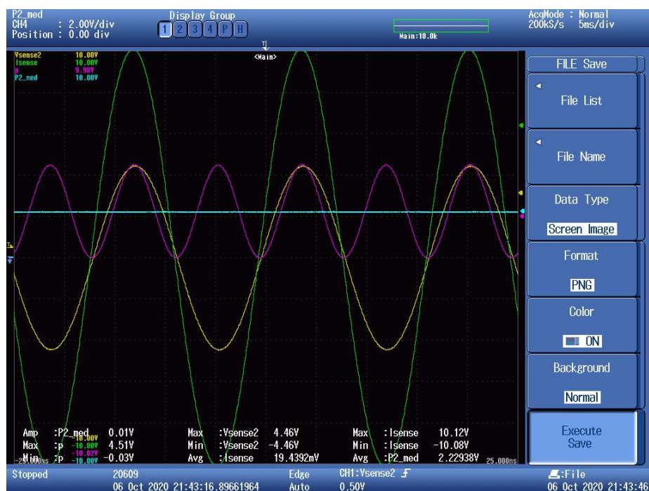
Figura 80 – Formas de onda obtidas no ensaio de potência de 3500 w
