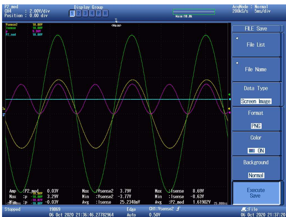
Figura 78 – Formas de onda obtidas no ensaio de potência de 2500 w
