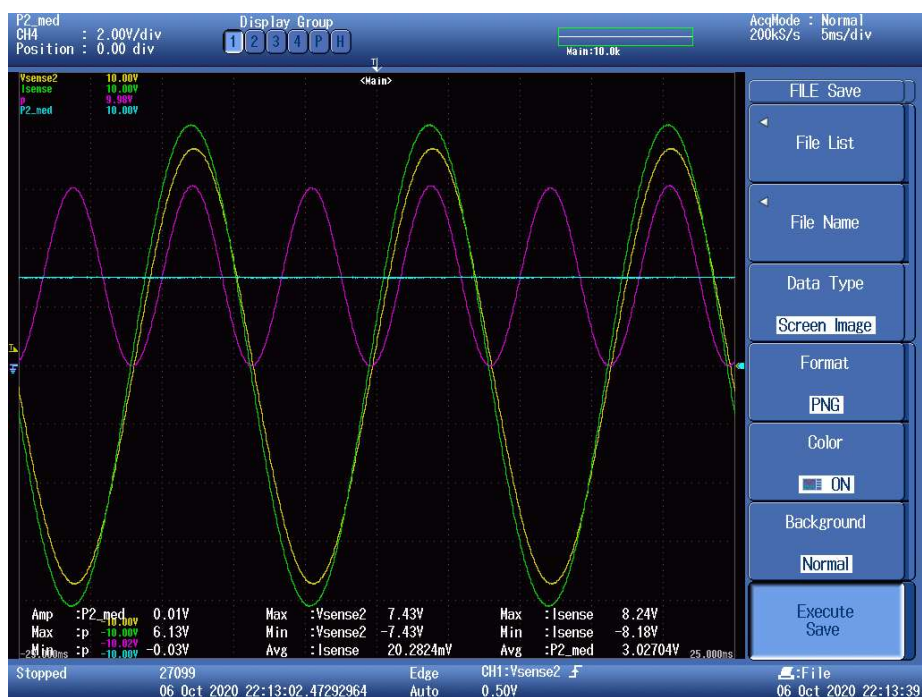
Figura 82 – Formas de onda obtidas no ensaio de potência de 4500 w
