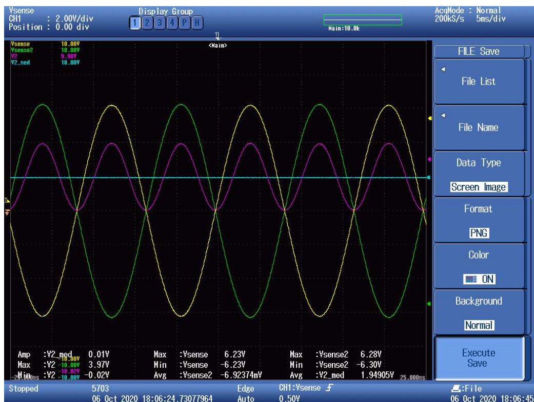
Figura 67 – Formas de onda obtidas no ensaio de tensão de 170 V
