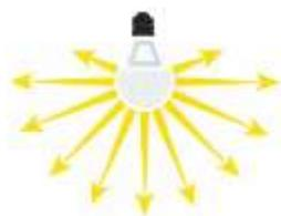
Figura 11 - Fluxo Luminoso ( $\Phi$ ) emitido por uma lâmpada [67].
