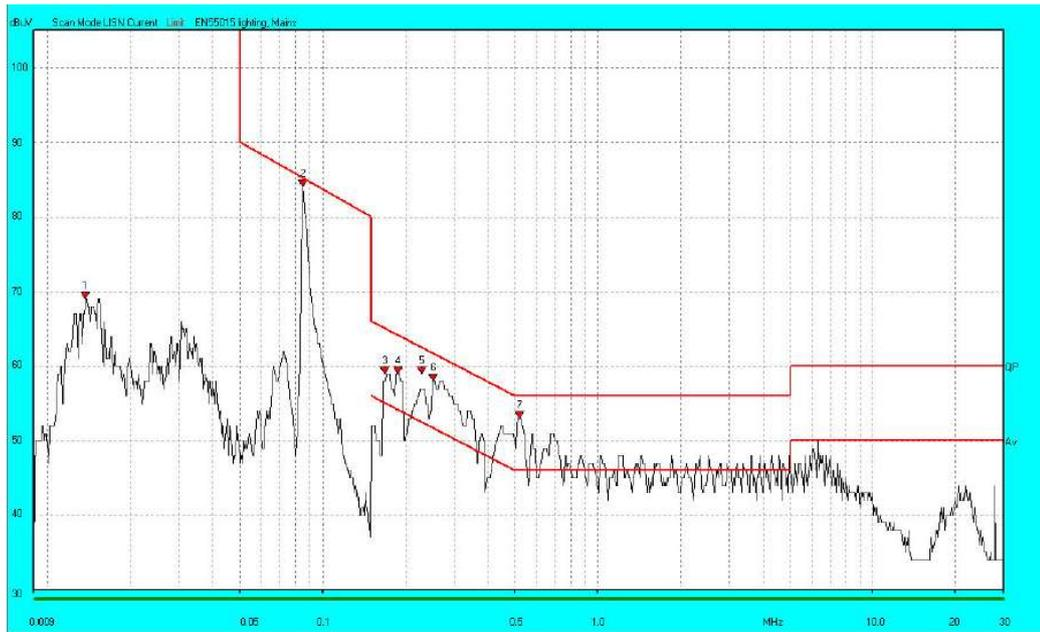
Figura 20 - Espectro de Frequência - Terminal Neutro (dB $\mu$ V) - 127V. Fonte: Gráfico gerado no *Software EMC Engineer v4.10* e retirado do relatório de ensaio do LABLUX.
