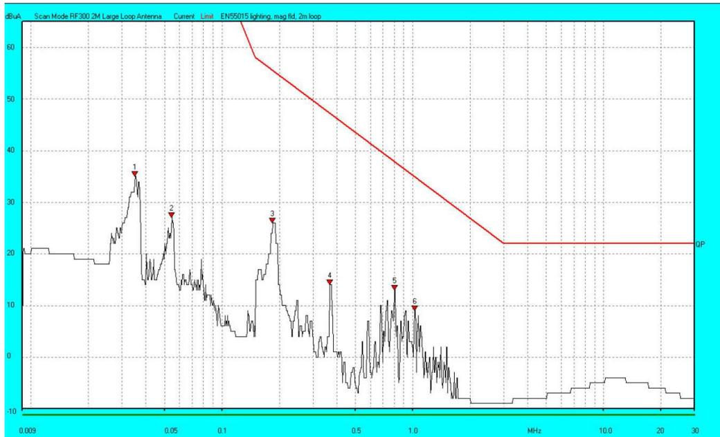
Figura 21 - Espectro de Frequência – Eixo X da antena Loop - Fonte: Gráfico gerado no *Software EMC Engineer v4.10* e retirado do relatório de ensaio do LABLUX.
