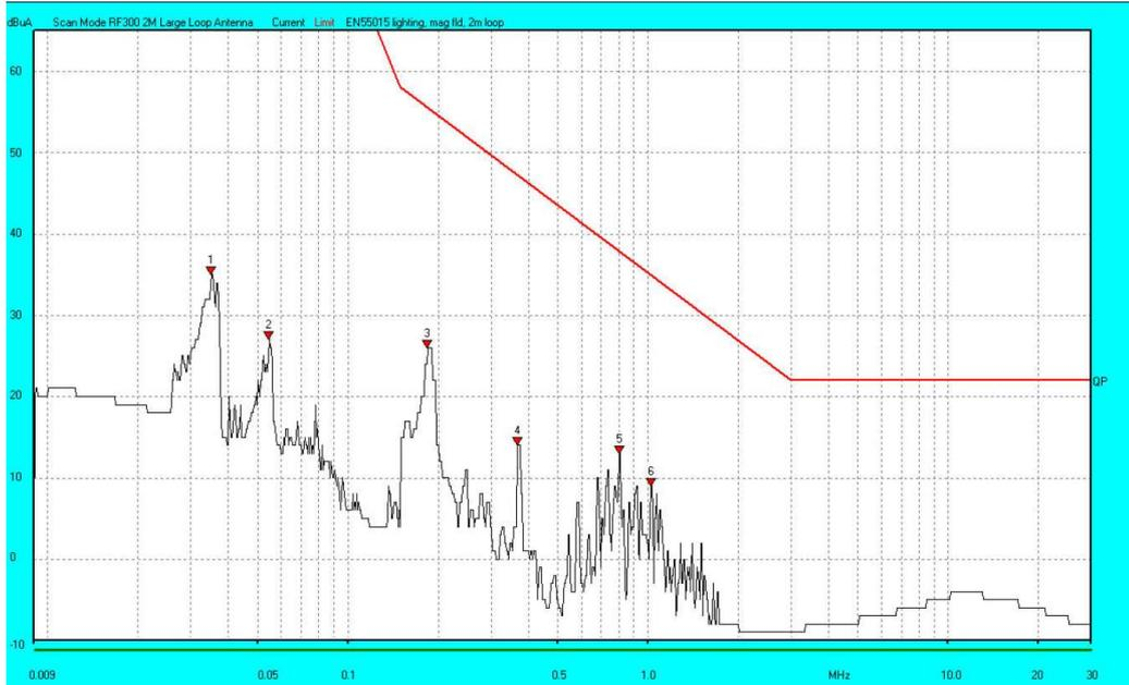
Figura 21 - Tensão de ensaio: 127V – Eixo X da antena Loop, Fonte: Gráfico gerado no *Software EMC Engineer v4.10* e retirado do relatório de ensaio do LABLUX.
