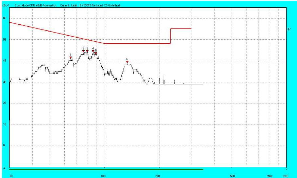
Figura 22 - Espectro de Frequência - 127V. Fonte: Gráfico gerado no *Software EMC Engineer v4.10* e retirado do relatório de ensaio do LABLUX.
