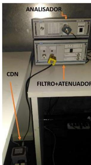
Figura 5 - Setup dos equipamentos utilizados durante a medição de perturbações radiadas (campo elétrico) das lâmpadas [18].
