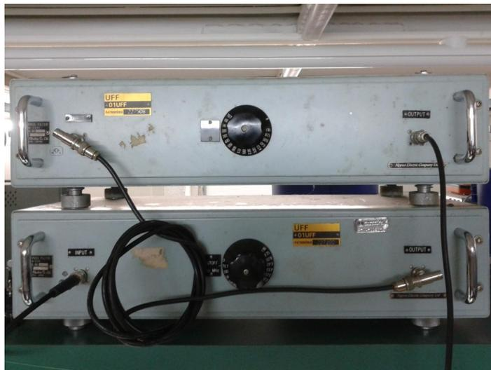
**Figura 4.17: Filtro passivo na configuração passa-faixa.**
