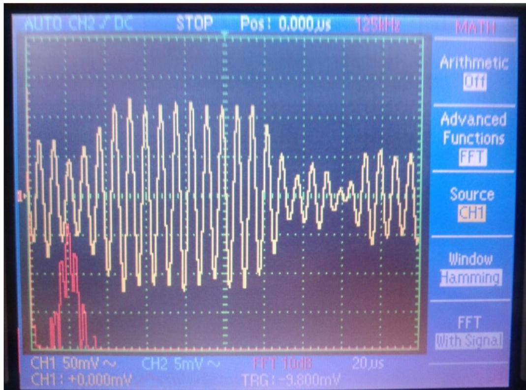
Figura 4.23: Sinal de saída no fotodetector para o melhor espelhamento com o bulbo de mercúrio num instante de tempo  $t_1$ .
