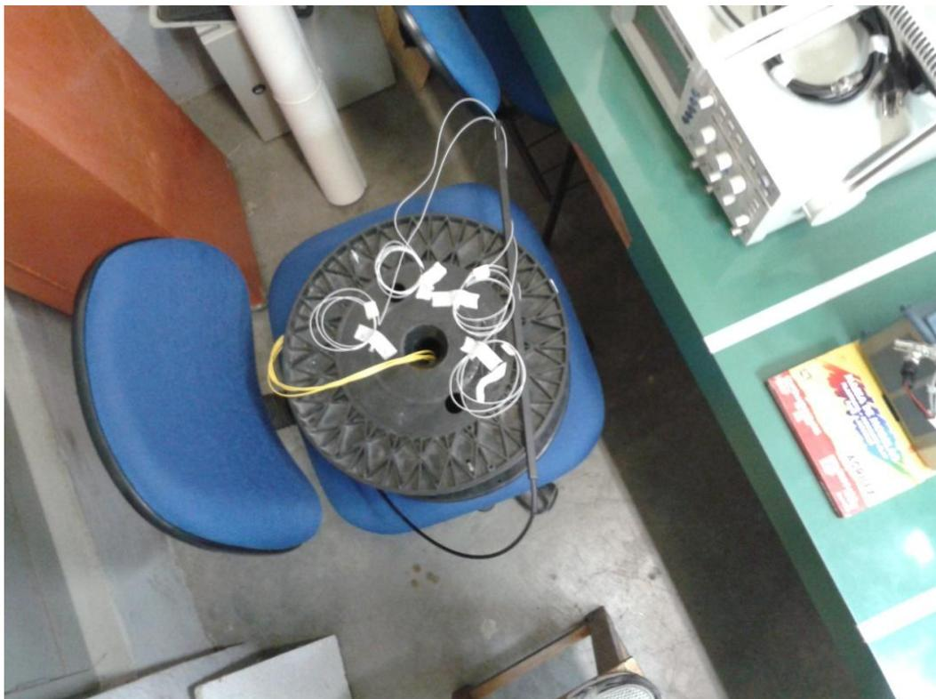
**Figura 5.2: Vista superior da bobina de cabo óptico contendo 4 fibras monomodo com saídas FC.**
