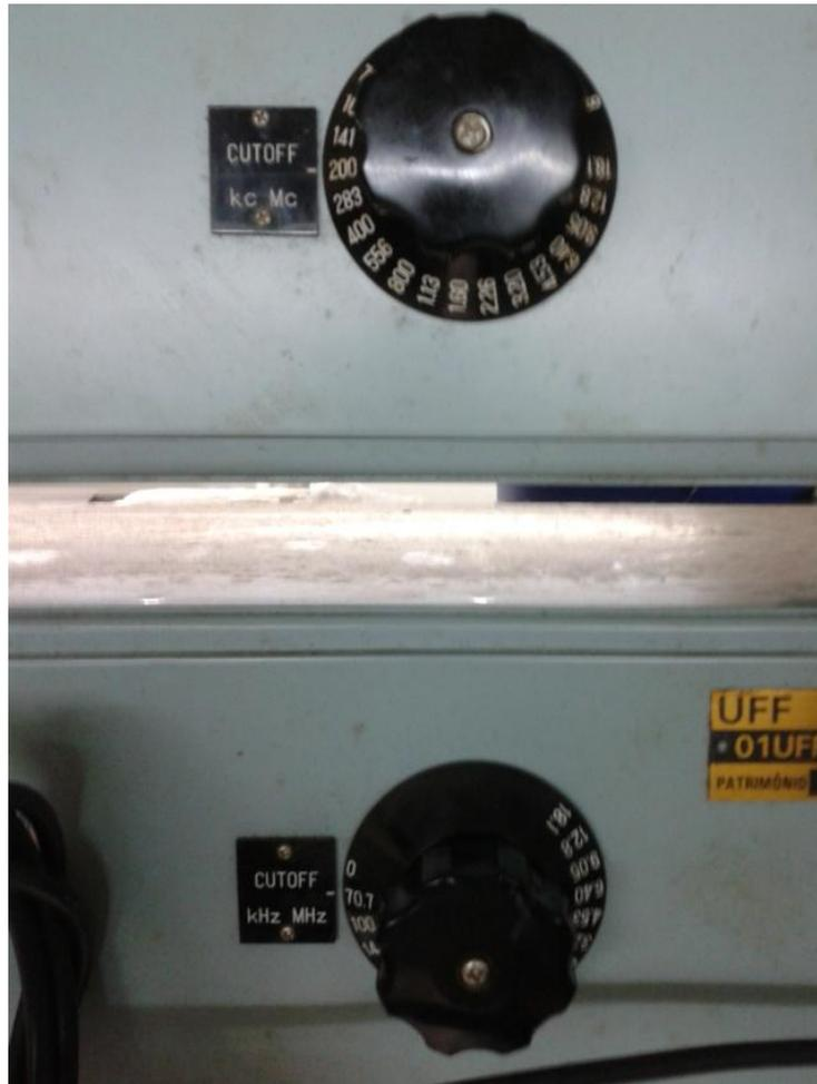
Figura 4.19: Configuração padrão do filtro passa-faixa: entre 70,7 a 200 KHz. As frequências de corte são pré-configuradas.
