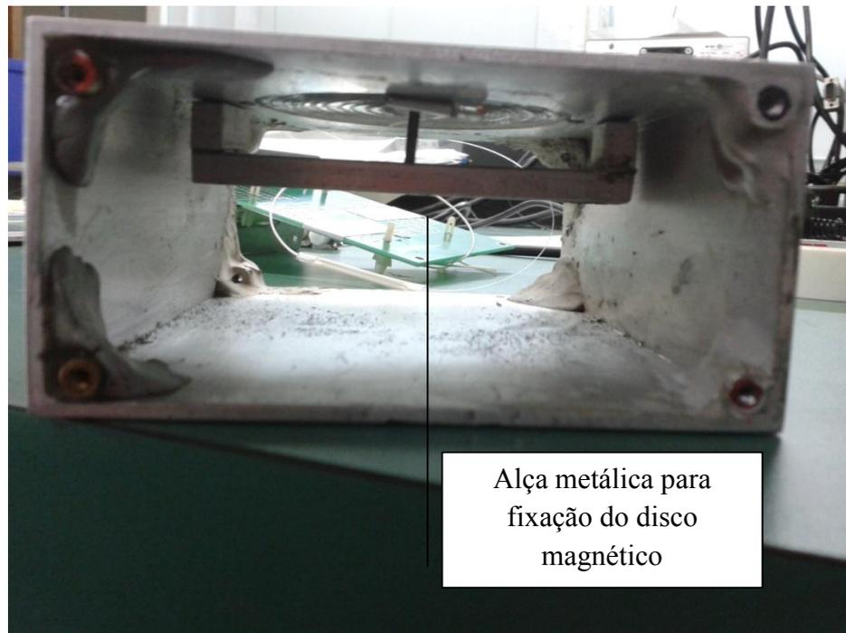
**Figura 4.52: Alça metálica para fixação do disco magnético à carcaça metálica.**
