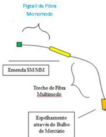
**Figura 4.20:** Trecho do protótipo MMI que foi sendo trocado para escolha do melhor ganho de espelhamento pelo bulbo de mercúrio.
