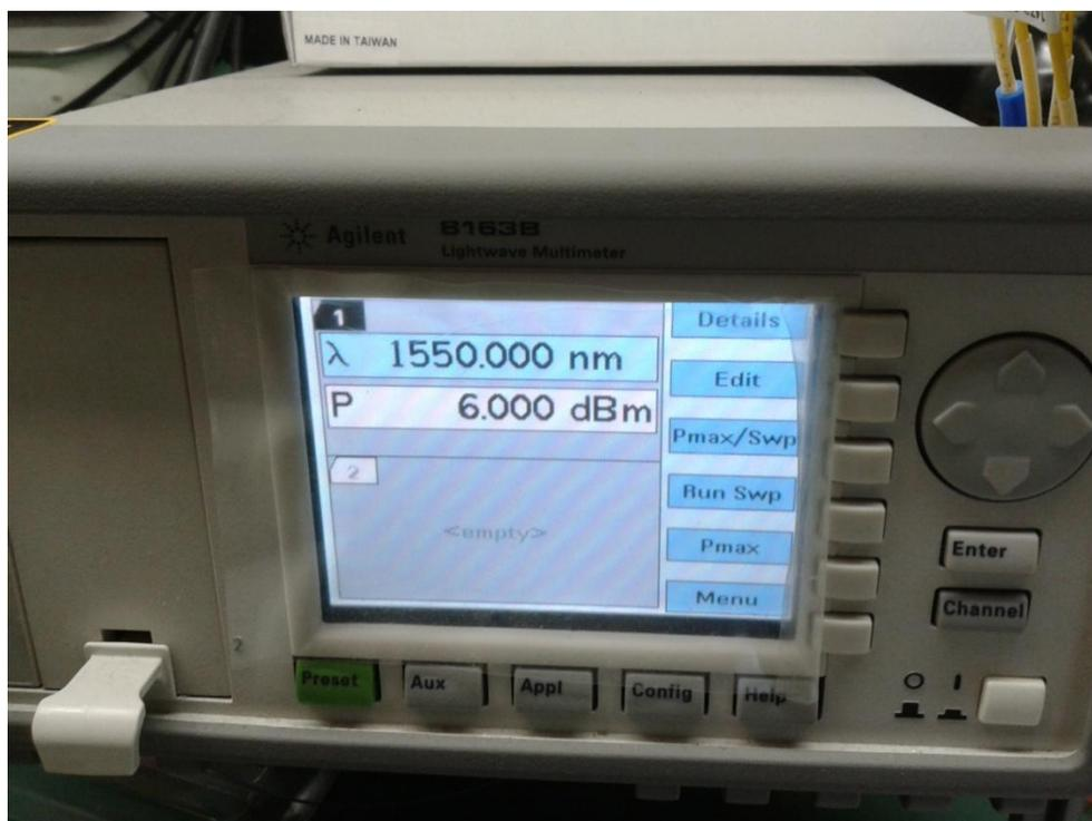
**Figura 4.9:** Configuração inicial do LASER para a operação do protótipo do sensor interferométrico.
