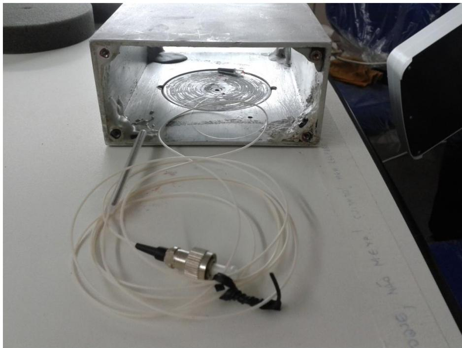
**Figura 4.50: Disco magnético ajustado na carcaça metálica do encapsulamento.**
