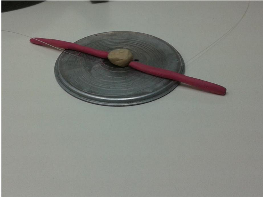
**Figura 4.47:** Esboço da colagem da fibra com o espaçamento na extremidade do disco para a fixação do bulbo.
