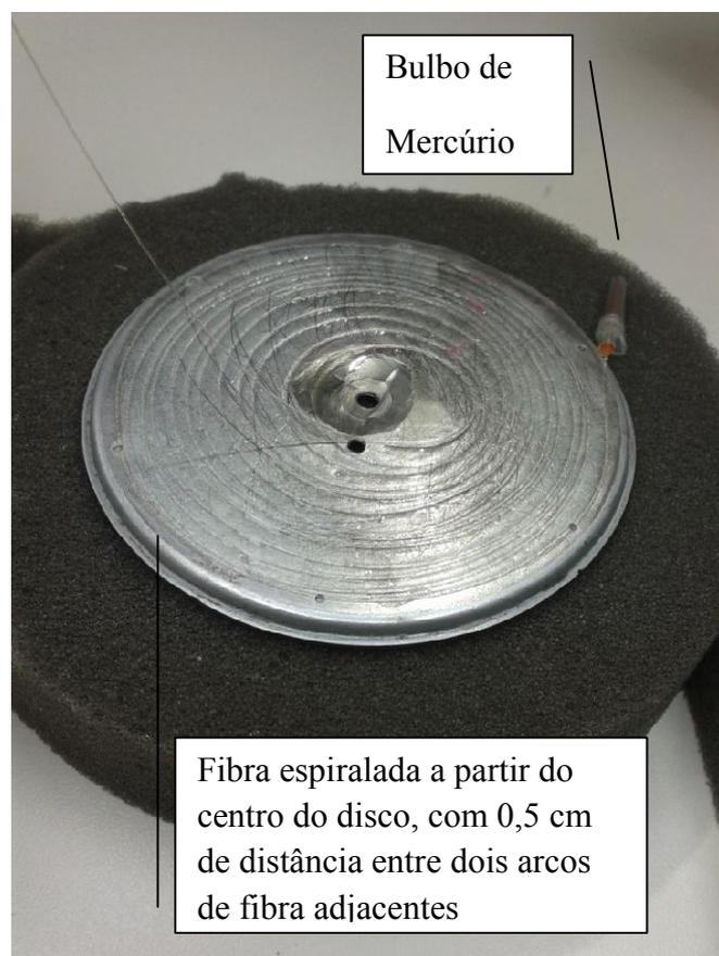
**Figura 4.49: Fibra espiralada no disco metálico secando, protegida contra choques com a ajuda de uma espuma.**
