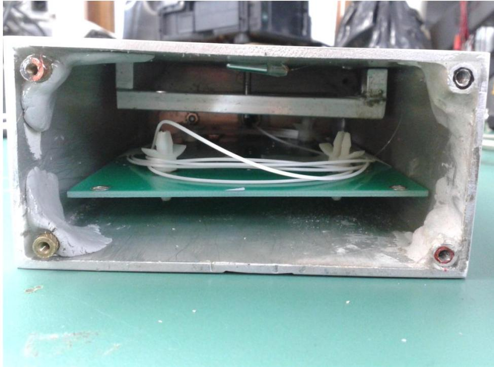
**Figura 4.53: Alça metálica para fixação do disco magnético e placa de suporte do pigtail monomodo ajustados dentro da carcaça metálica.**
