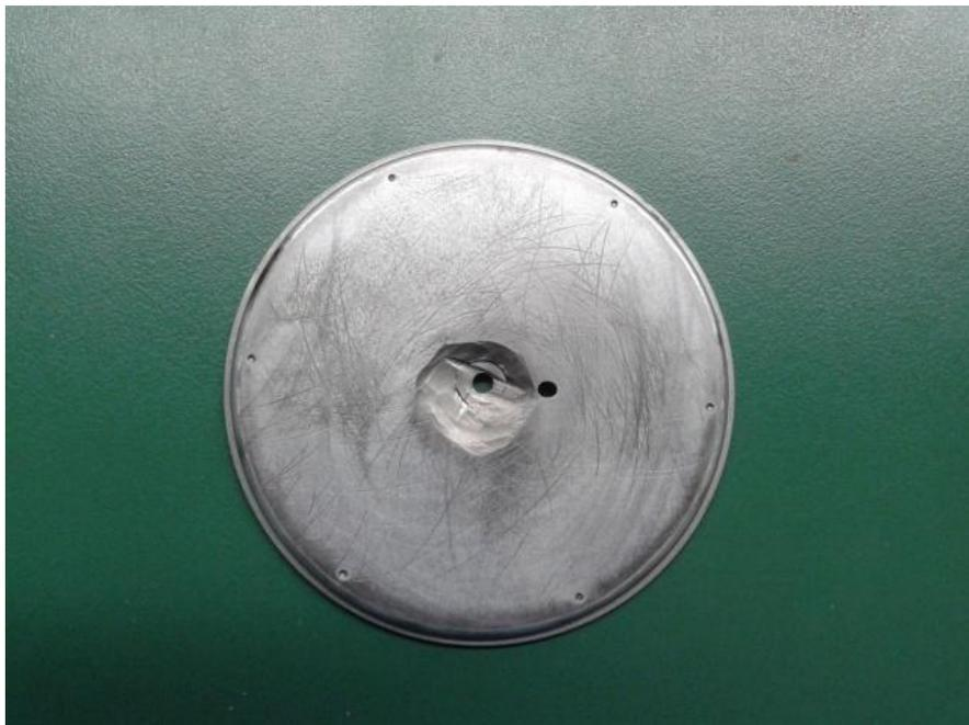
**Figura 4.45: Parte traseira do disco magnético que foi acoplado à carcaça metálica do sensor interferométrico multimodal.**
