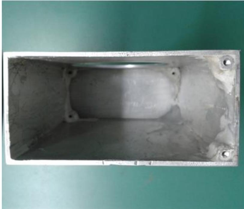
**Figura 4.34:** Exemplo da colagem de 2 suportes metálicos para rosqueamento dos parafusos com resina epóxi.
