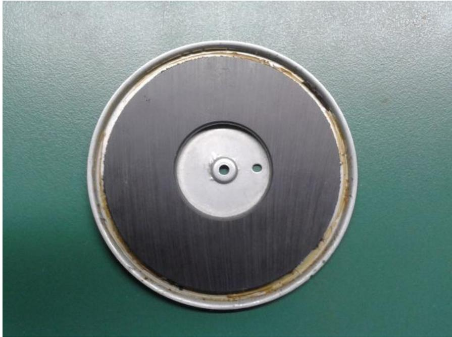
**Figura 4.44: Parte frontal do disco magnético que foi acoplado à carcaça metálica do sensor interferométrico multimodal.**
