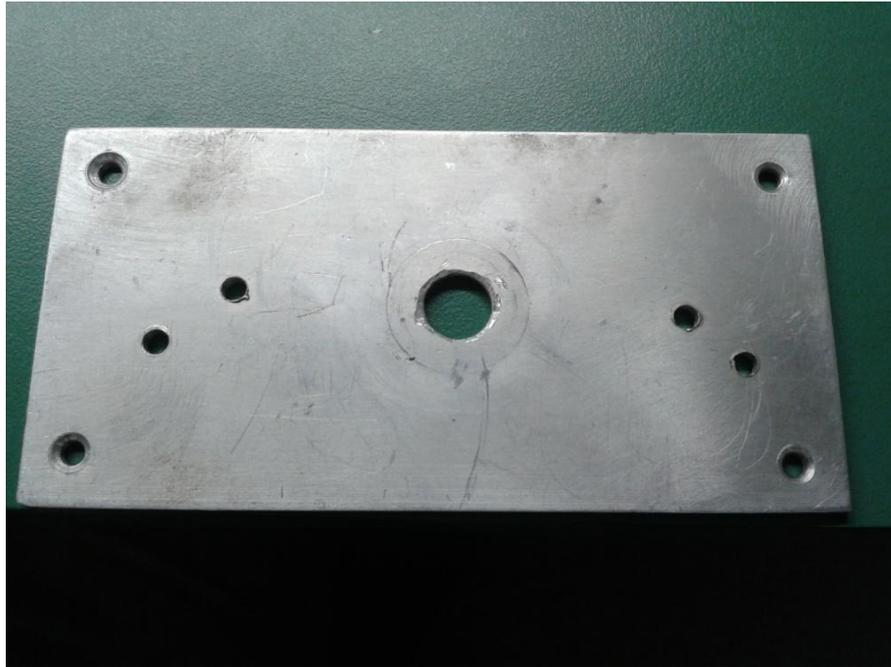
**Figura 4.37: Tampa com 5 orifícios para fixação de componentes, além dos 4 para a fixação da tampa.**
