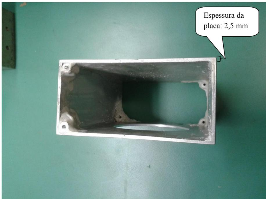
**Figura 4.30: Vista lateral da envoltória metálica do encapsulamento.**
