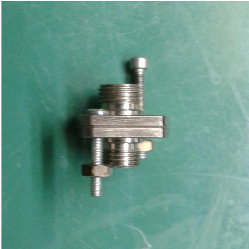
**Figura 4.36: Adaptador FC para fixação em uma das tampas do invólucro.**
