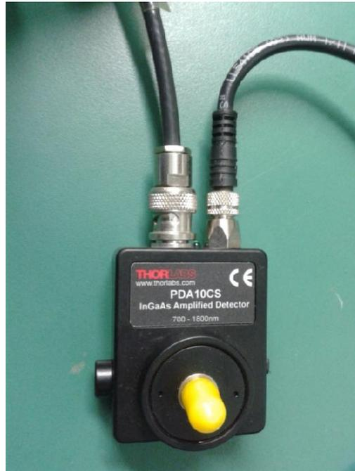
**Figura 4.15: Fotodetector usado na construção do sensor modalmétrico.**
