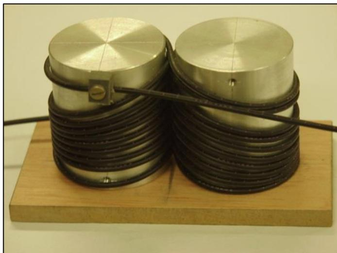
**Figura 28: Fotografia do misturador de modos padrão japonês, modelo JIS6863, onde 3,4m de comprimento de POF são enroladas em dois cilindros metálicos em formato de oito.**
