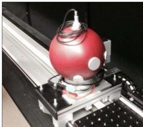
Figura 33: Esfera integradora do laboratório do *Polymer Optical Fiber Application Center (POFAC)* da utilizada nesta etapa.
