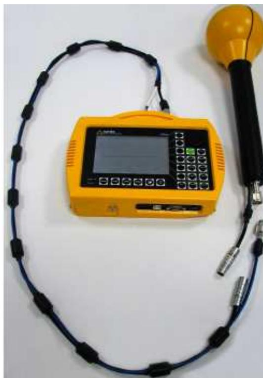
**Figura 8.16 - Equipamento SRM-3000, utilizado nas medições.**
