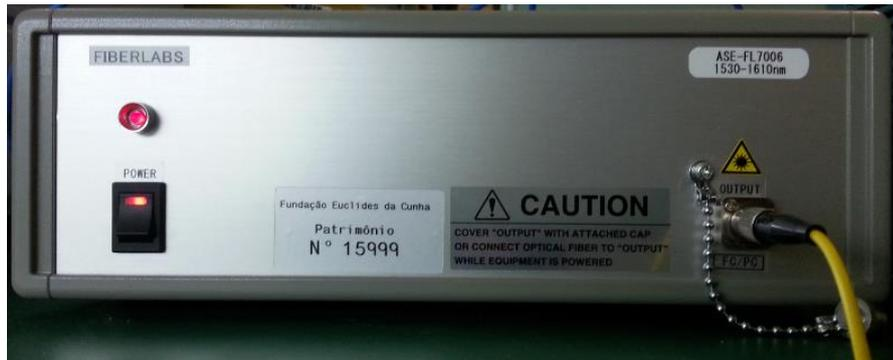
Figura 4.2 – Imagem frontal de uma Fonte de ASE operando na banda C e L utilizada no experimento.
