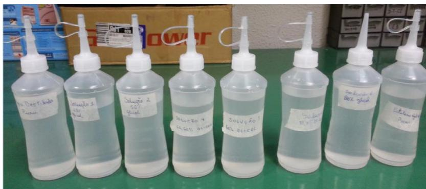
Figura 4.22 – Recipientes com diferentes concentrações de etileno glicol em água destilada. Índices de refração variando de 1,333 a 1,429.
