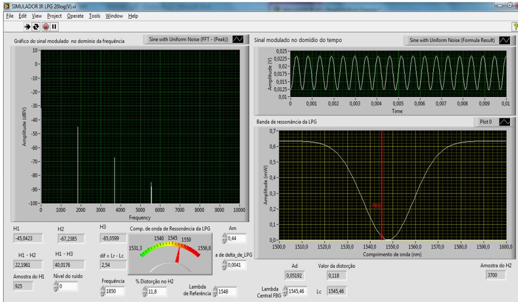
Figura 4.29 - Programa Labview para simulação do sistema de interrogação.
