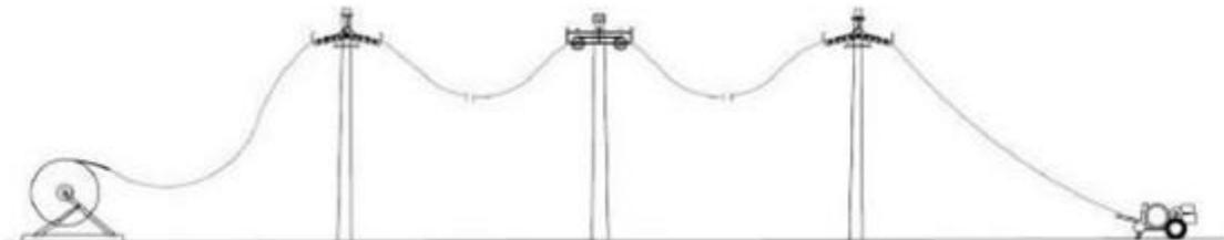
**Figura 62 - Cabo Elicord – Traçado do Cabo - Fonte Distribuidora A**
