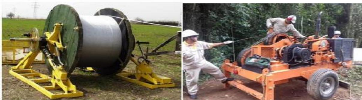
**Figura 63 - Cabo Elicord – Freio e Puller respectivamente - Fonte Distribuidora A**
