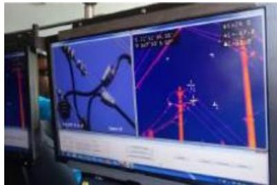
**Figura 27 - Sistema identificando pelo mapa de cores as temperaturas nas estruturas e componentes - Fonte Distribuidora A**
