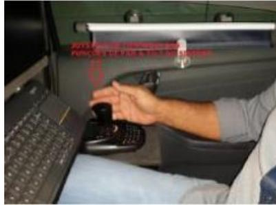
**Figura 26 - Sistema de Joystick para direcionar o ponto correto do leitor de termovisão - Fonte Distribuidora A**
