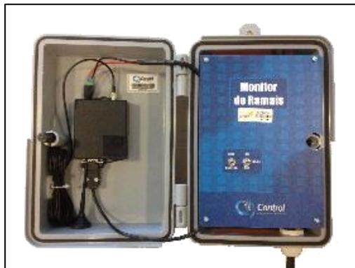
**Figura 38 - Monitor de Ramal para atuar como apoio na identificação de “faltas” - Fonte Control**
