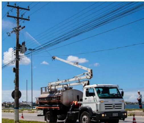
**Figura 29 - Carro tanque com Sistema de jateamento de água a distância controlado por Joystick - Fonte Distribuidora A**
