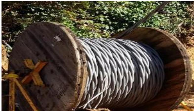
**Figura 55 - Cabo Elicord - Fonte Distribuidora A**
