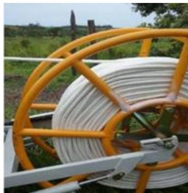
**Figura 60 - Cabo Elicord – Cabo Guia - Fonte Distribuidora A**
