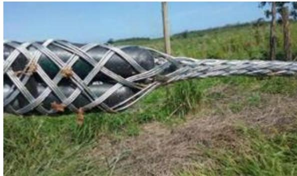
**Figura 61 - Cabo Elicord – Camisa de Puxamento - Fonte Distribuidora A**
