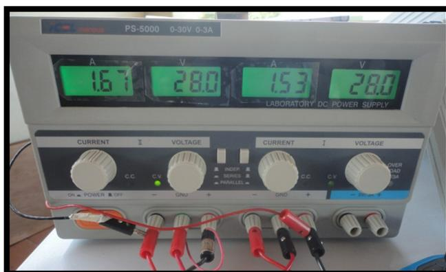
**Figura 3-5 – Fonte de alimentação para alimentar o PA.**
