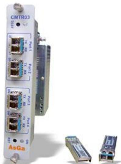
**Figura 53:** Placa com módulos XFP em seus conectores [50]
