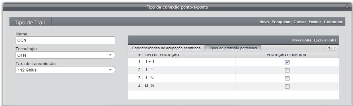
**Figura 123:** Tipos de proteção permitidos para o tipo de *trail* OCh
