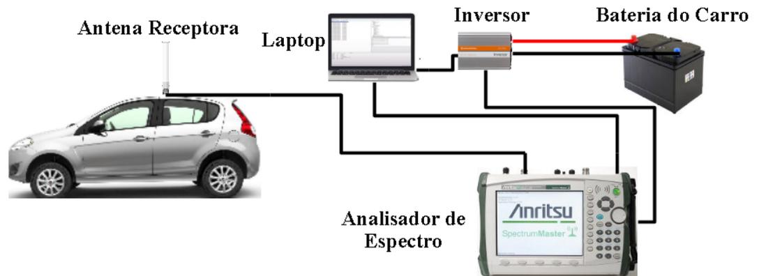
Figura 25 – Configuração do sistema receptor para as medidas de faixa estreita.
