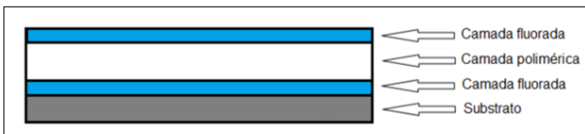
Figura 2: Esquema dos filmes PMMA depositados sobre substrato de silício. [8]
