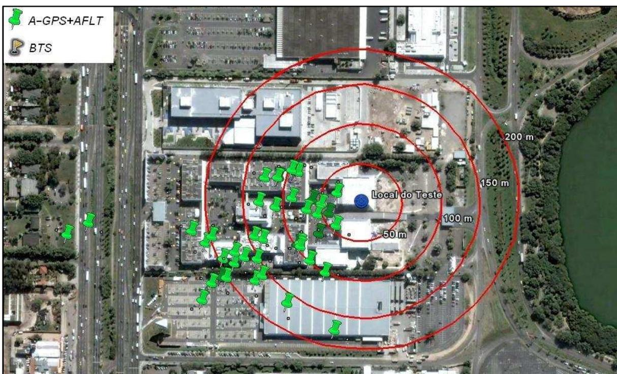
Figura 6-92: Chamadas de teste (método A-GPS+AFLT).
