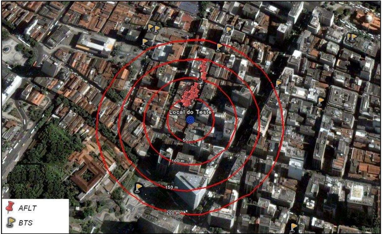
Figura 6-61: Chamadas de teste (método AFLT).
