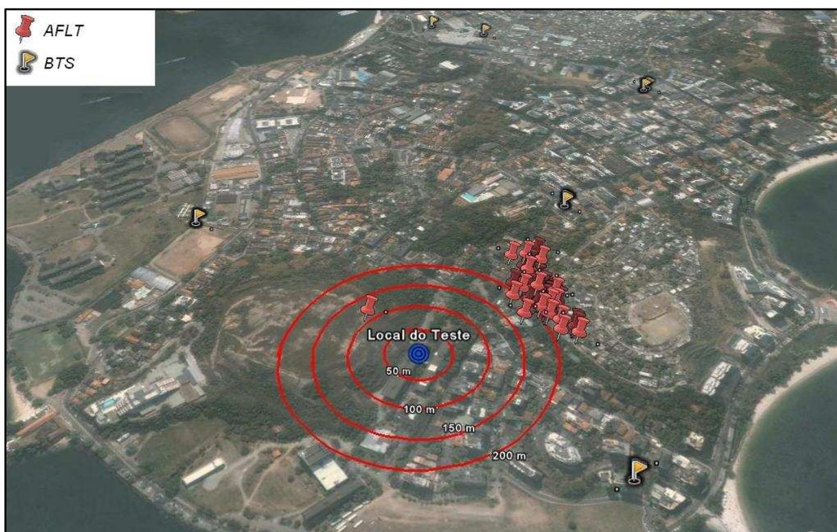
Figura 6-104: Chamadas de teste (método AFLT).
