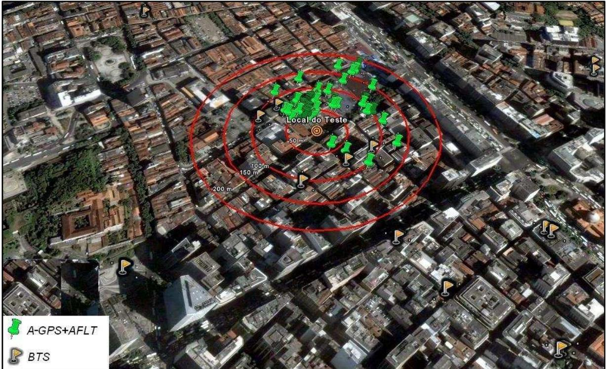
Figura 6-19: Chamadas de teste (método A-GPS+AFLT).
