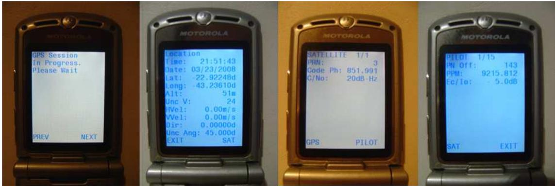
Figura 6-2: Terminal CDMA com GPS Assistido integrado utilizado em modo teste.
