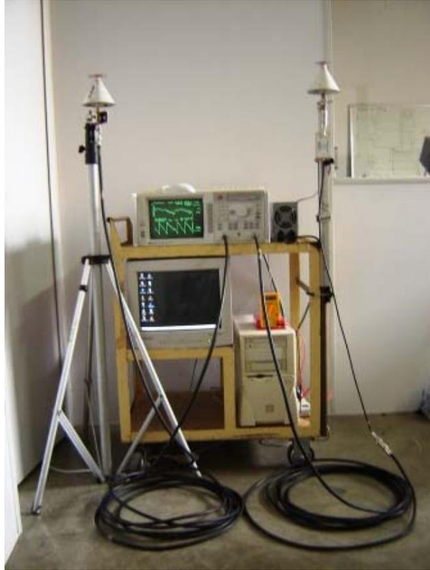
Fig 3.6 – Foto do Sistema Utilizado na Sondagem em Freqüência.
