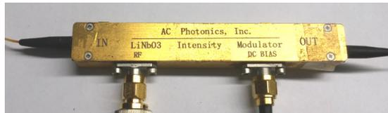
Para que o MZM opere no ponto de quadratura, ele foi alimentado com 4,6 V ( $= V_{\pi}/2$ ). A figura figura 22 ilustra o comportamento de um MZM quando opera no ponto de quadratura, através de um função de transferência.
