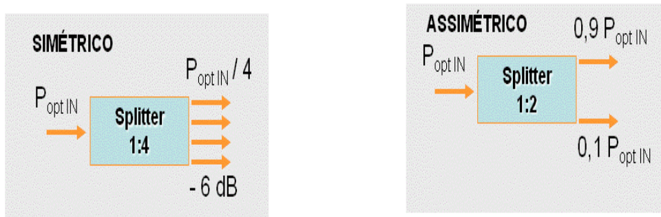
Figura 2.20: Divisor de potência simétrico (1:4) e assimétrico (90/10) Fonte: Furukawa
