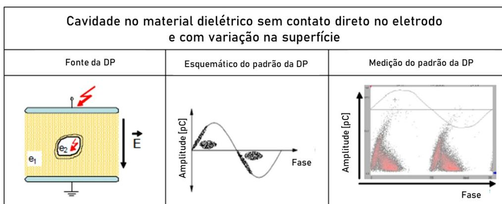
Figura 2.23: Diagrama relacionado a fase para cavidade no dielétrico sem contato com o eletrodo e com superfície modificada pelas descargas [33].
