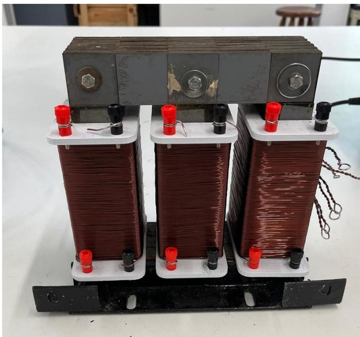
Figura 4.9: Transformador trifásico construído.
