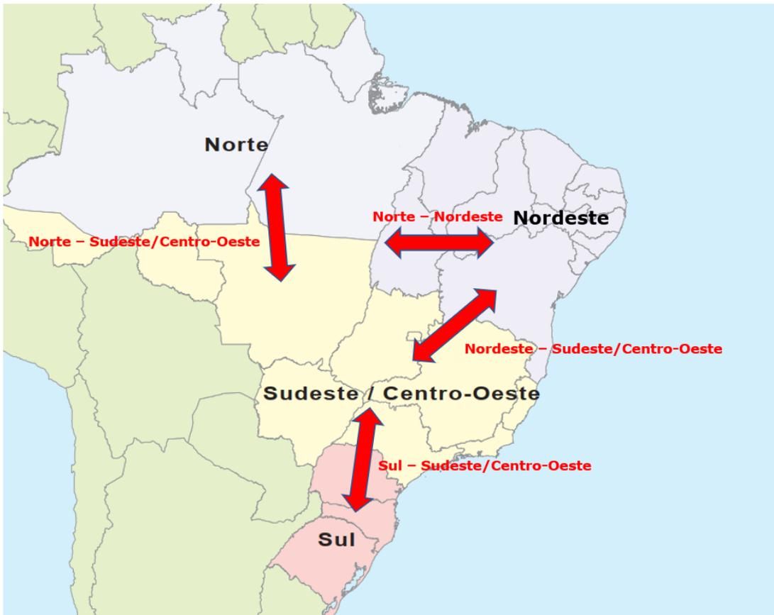
Figura 2.4: Interligações entre Áreas Elétricas do SIN
