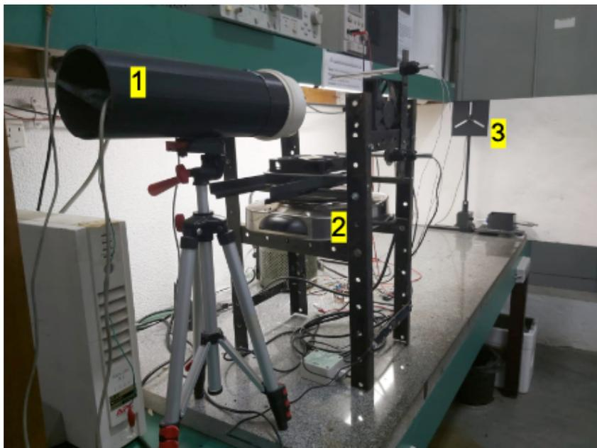
Figura 9 - Conjunto transmissor (1), fonte de calor (2), sistema de recepção (3)
