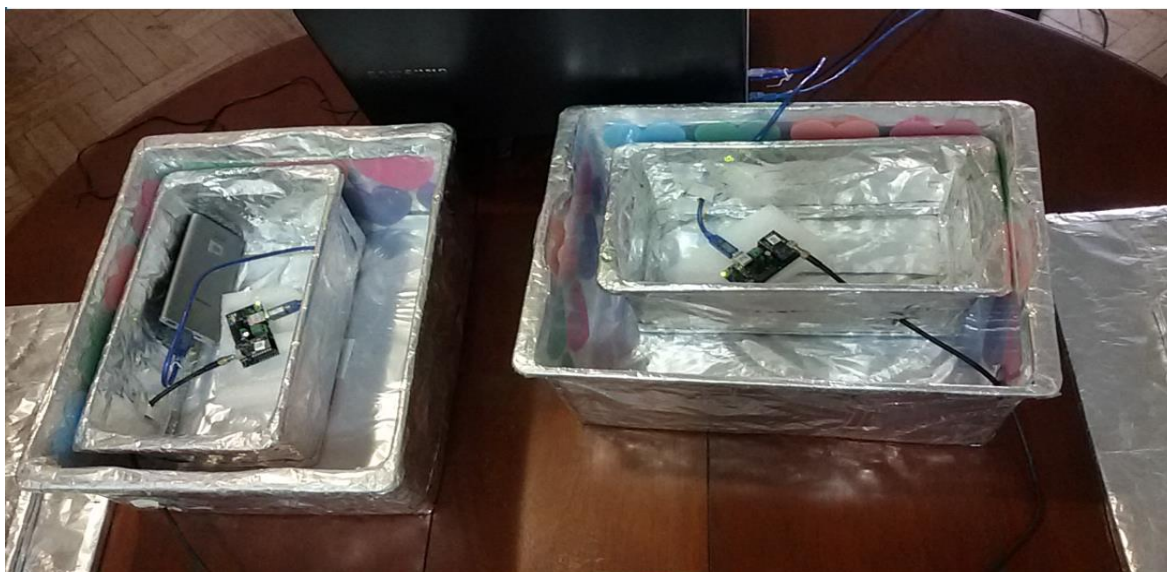
Figura 77. Rádios no interior de caixas cobertas com duas camadas de papel alumínio cada.
