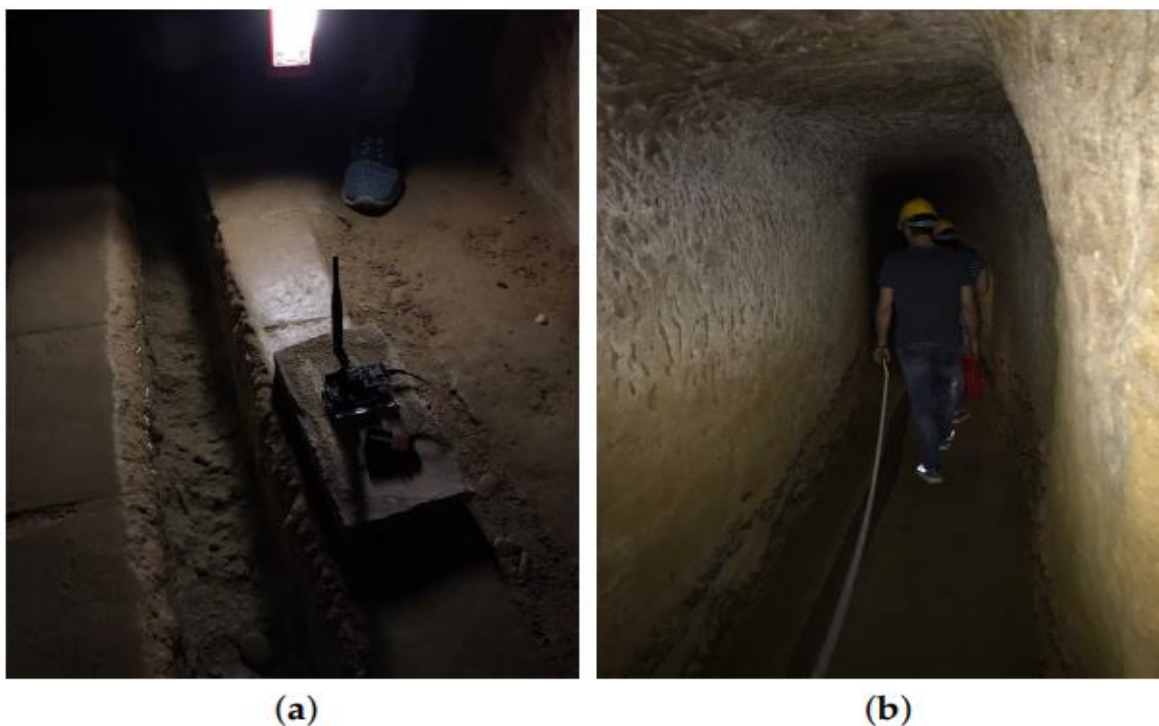
Figura 64. Galerias “Bottini”, embaixo do centro da cidade de Siena, Itália. No lado (a), um módulo LoRa colocado no chão de uma das galerias. Em (b), medições de sinal pela equipe.
