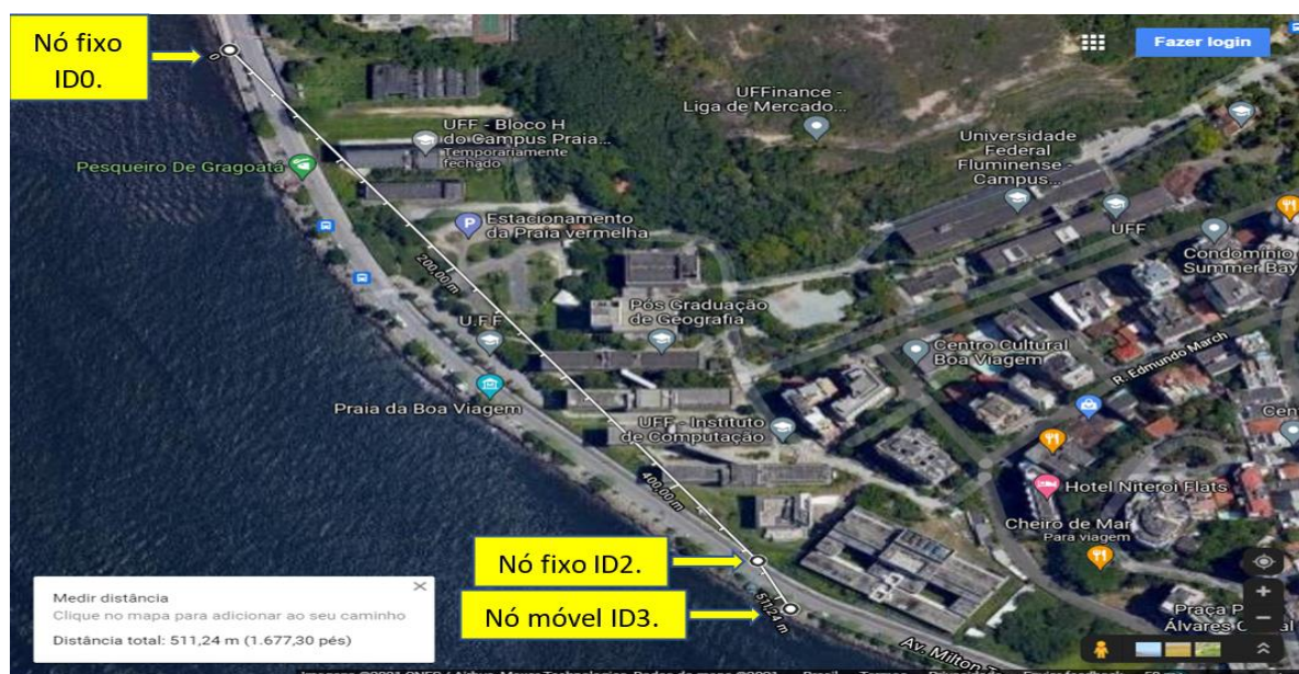
Figura 137. Vista aérea mostrando as posições dos nós ID0, ID2 e ID3 quando ID3 encontrava-se em frente ao primeiro poste depois daquele onde foi fixado ID2, no sentido da Ilha da Boa Viagem.
