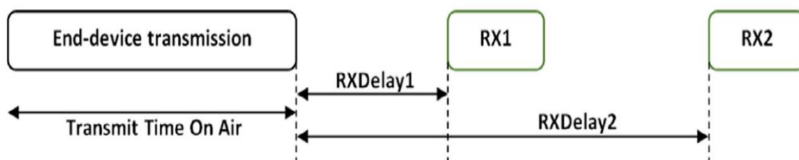
Figura 7. Comunicação bidirecional entre um dispositivo final LoRaWAN da classe A e uma estação-base. Fonte: MEKKI et al. [5].
