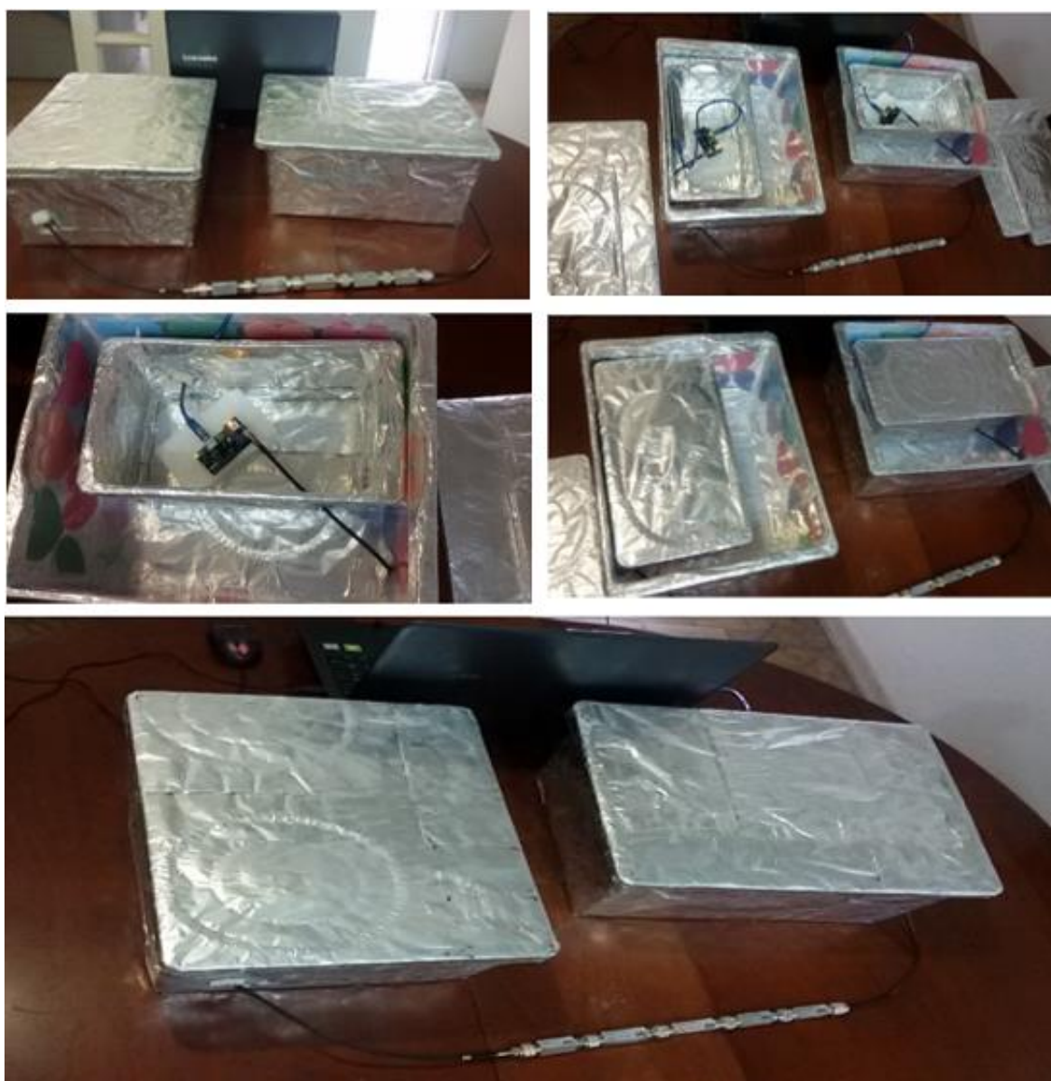
Figura 80. Rádios no interior de caixas cobertas com duas camadas de papel alumínio cada.
