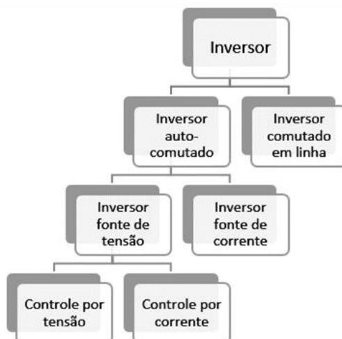
**Figura 13- Classificação dos tipos de inversores [74]**
