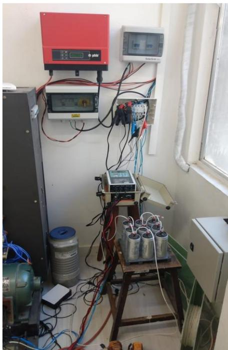
**Figura 70 – Medição do sistema conectado com carga e filtro.**
