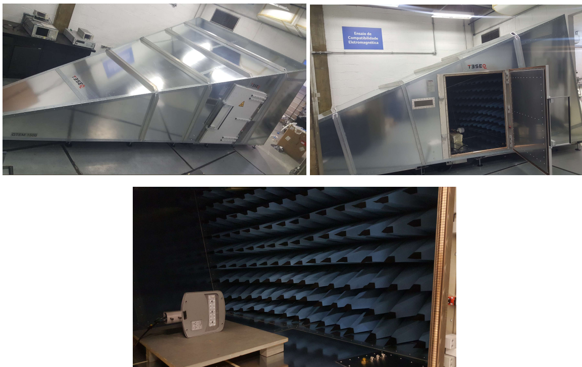
Figura 19: Área de ensaios de EMC (GTEM) do Laboratório de Eficiência Energética do Cepel.
