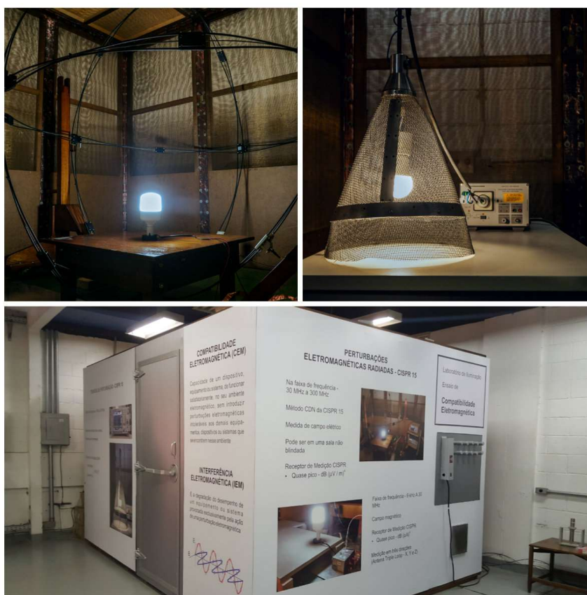
Figura 18: Área de ensaios de EMC (Antena Triple Loop ) do Laboratório de Eficiência Energética do Cepel.
