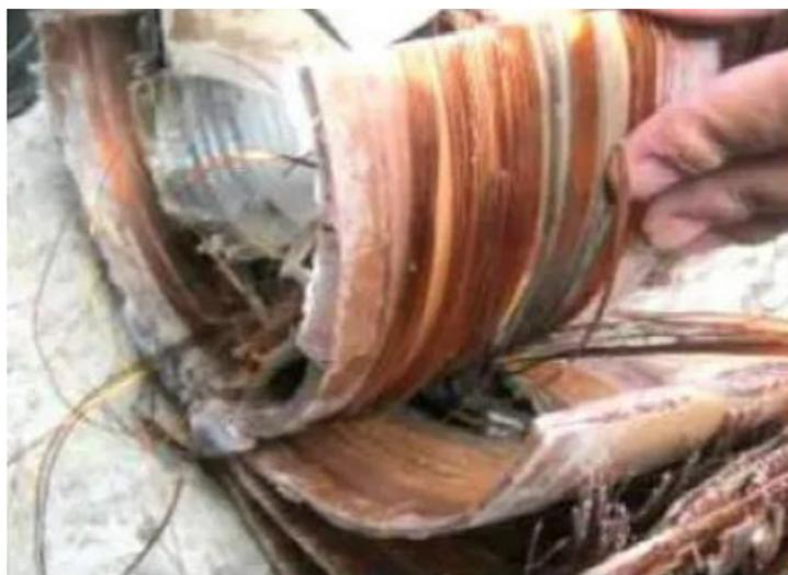
Figura 16 – Efeitos da ferrorressonância nos enrolamentos primários do transformador de tensão (AKTIF, 2021).
