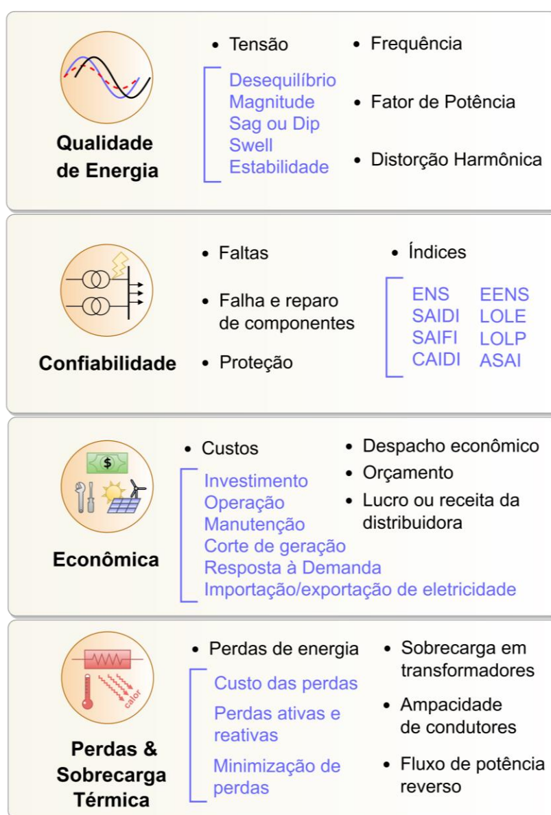
Figura 6- Representação dos principais índices e características das áreas de análise de redes elétricas
