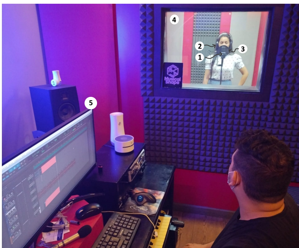
Figura 5.1: Processo de gravação da voz da Soprano 4 com os equipamentos utilizados no estúdio de gravação 2: (1) Microfone Shure KSM32/SL (Condenser, Digital), (2) Fones de ouvido para monitoramento, (3) Anti-pop , (4) Cabine de gravação, (5) Estação de Áudio Digital (DAW).
