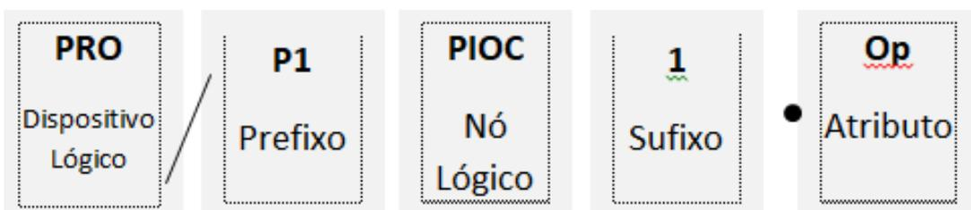
Figura 5.21: Elaborado pela própria Autora - Nomenclatura do IED SEL 451 utilizado, de acordo com os campos da Norma.
