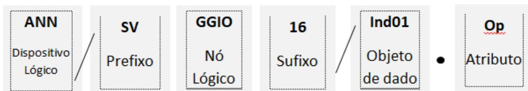
Figura 5.14: Elaborado pela própria Autora - Nomenclatura do IED SEL 735 utilizado, de acordo com os campos da Norma.
