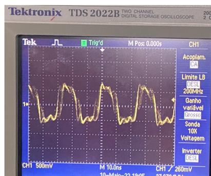
Fig. 5. Traço de osciloscópio do sinal de saída emitido pelo F8L em *mode-locking* passivo na forma de pulsos retangulares para  $I_{bias} > 380$  mA.
