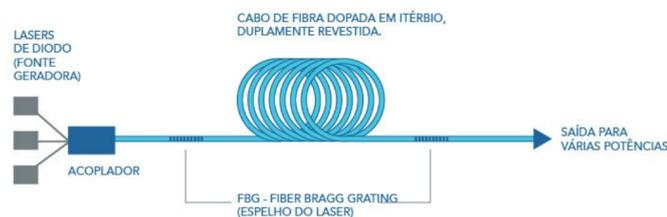
Figura 2.22: Configuração do laser à fibra óptica.[24].
