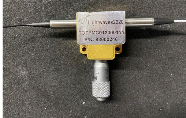
Figura 3.12: Filtro óptico passa-banda de 1,2 nm de janela espectral utilizado no experimento que pode ser sintonizado na banda C (1520-1565 nm).
