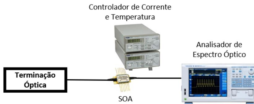
Figura 3.3: Esquema experimental para a caracterização do espectro da ASE.
