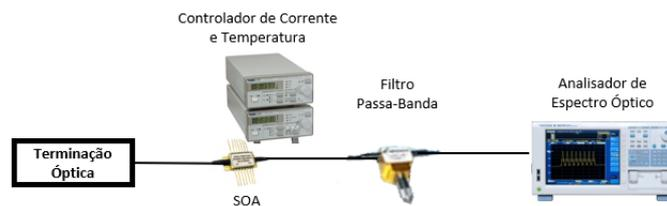
Figura 3.13: Esquema experimental para a medida do espectro da ASE com filtro passa-banda.
