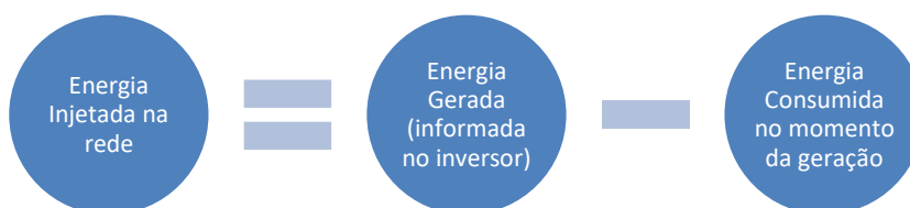
Figura 17 - Modelo esquemático da energia injetada na rede
