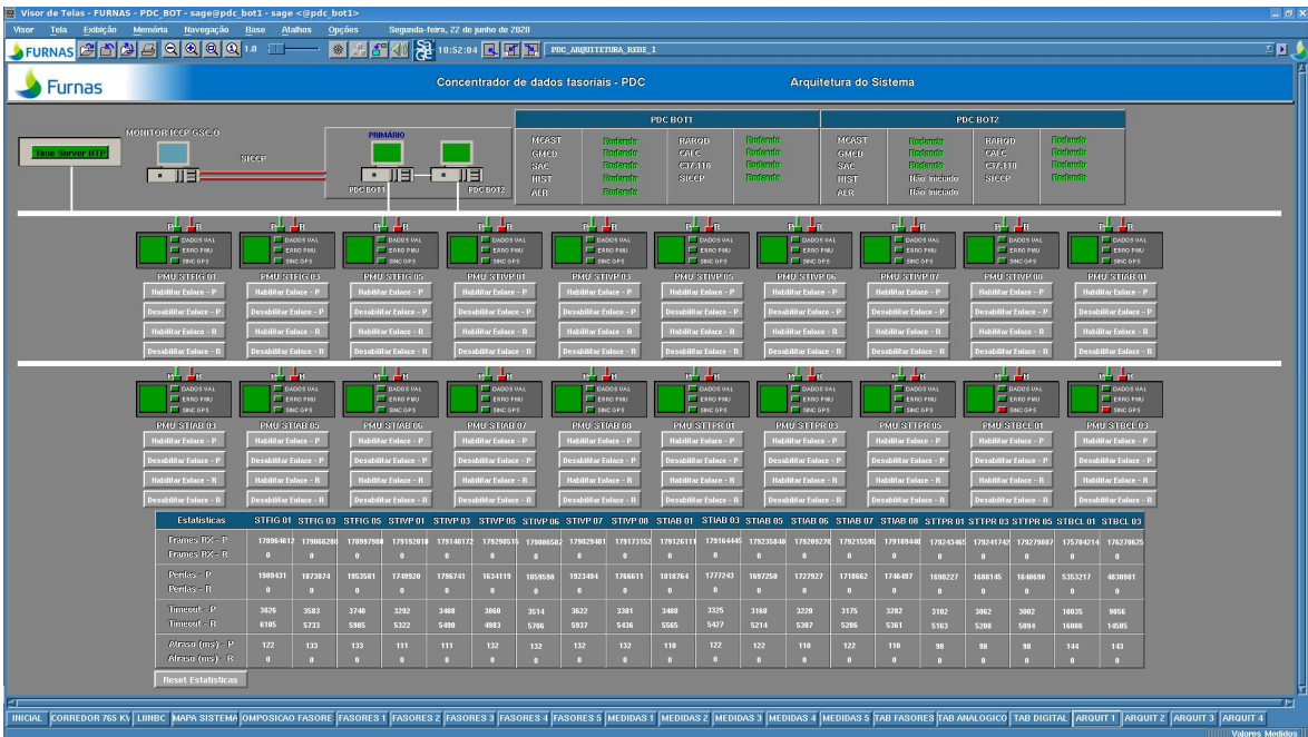
Figura 27 – Tela de monitoramento de arquitetura – ligações, atrasos e perdas
