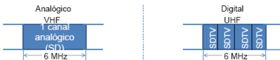
**Figura 1 - Utilização da banda de 6 MHz na DTV. [4]**
