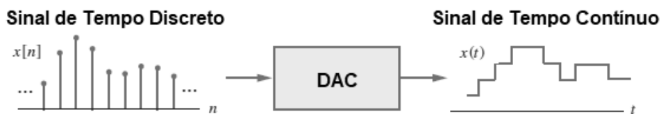
Figura 3.7: Conversão Digital Analógica após Zero-Order-Hold
