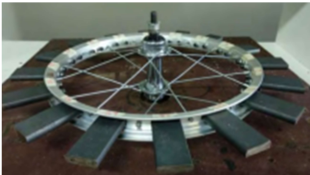
Figura 63 – Rotor construído em aro 16 (aro comercial) descartado (Elaboração Própria).
