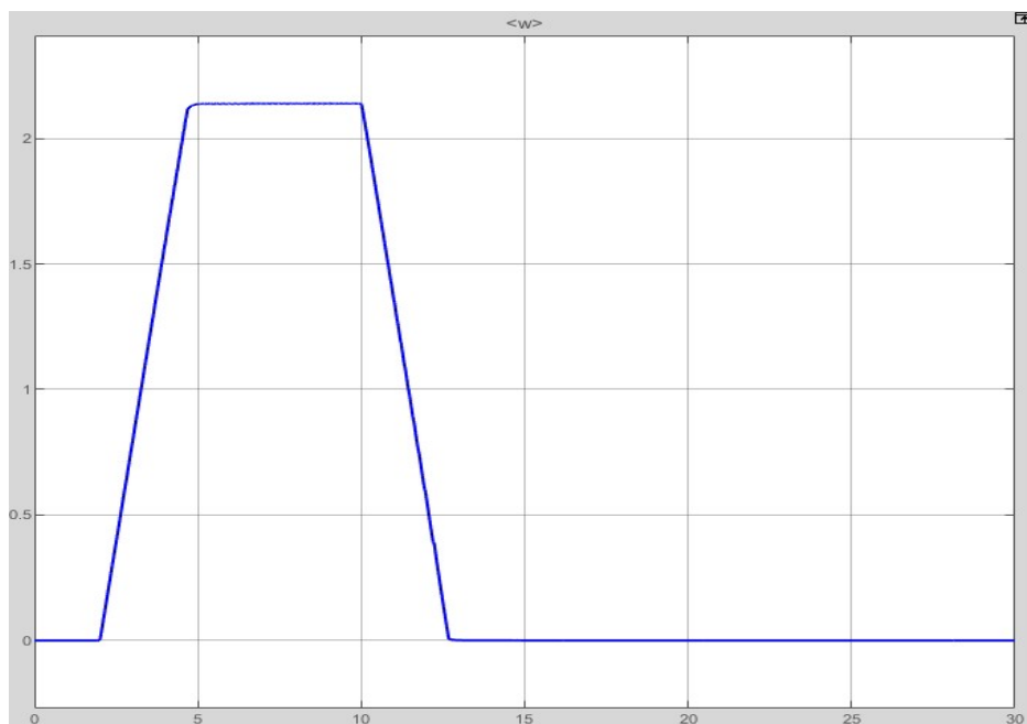
Figura 48 – Velocidade de rotação do motor na Movimentação Partindo do Repouso. Escalas: Ver:0,5 rad/s/div; Hor: 5 s/div (Elaboração Própria).
