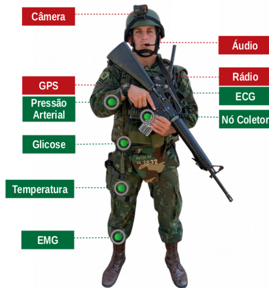
Figura 2.1: Dispositivos vestíveis em um combatente.
