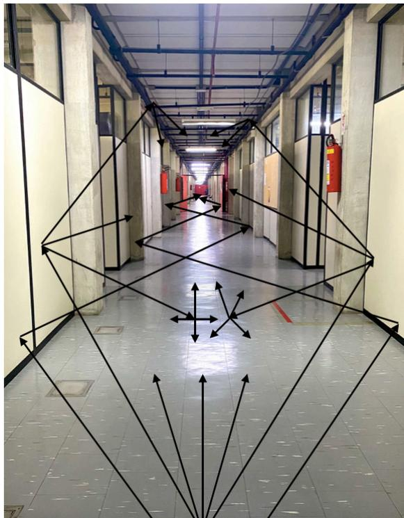
Figura 6.28: Canalização das ondas eletromagnéticas.
