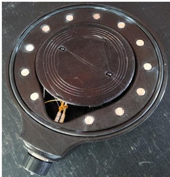
**Figura 37 – Sensor fabricado com fibra óptica**
