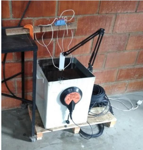
**Figura 38 – Cuba de geração de descargas artificiais**
