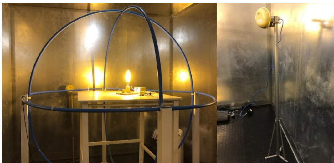
Figura 17 – (a). Apresenta a bancada onde as lâmpadas em teste ficaram dispostas. (b). Apresenta uma das antenas do sistema de transmissão de dados juntamente com um roteador modelo Bullet M2.
