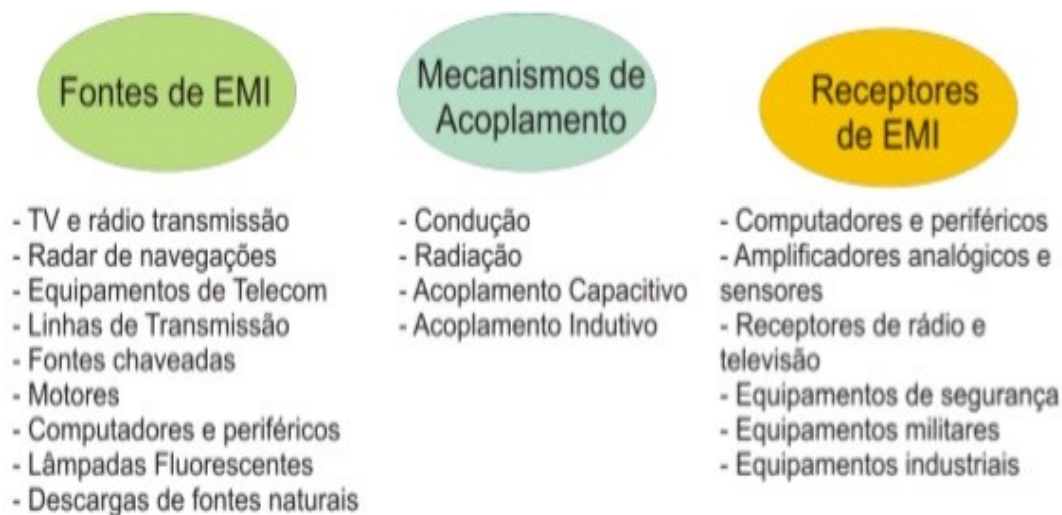
Figura 2 - Componentes de uma situação de EMI.
