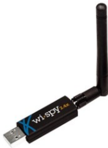
Figura 13 - Analisador de Espectro Wi-Spy 2.4x
