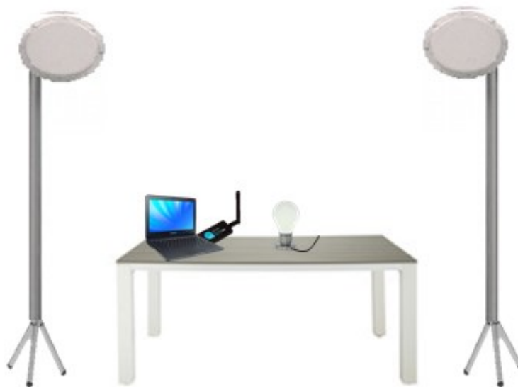
Figura 14 - – Esquema de montagem da bancada utilizada no Teste 2, com duas antenas, uma lâmpada, um computador e o analisador de espectro (Wi-Spy).
