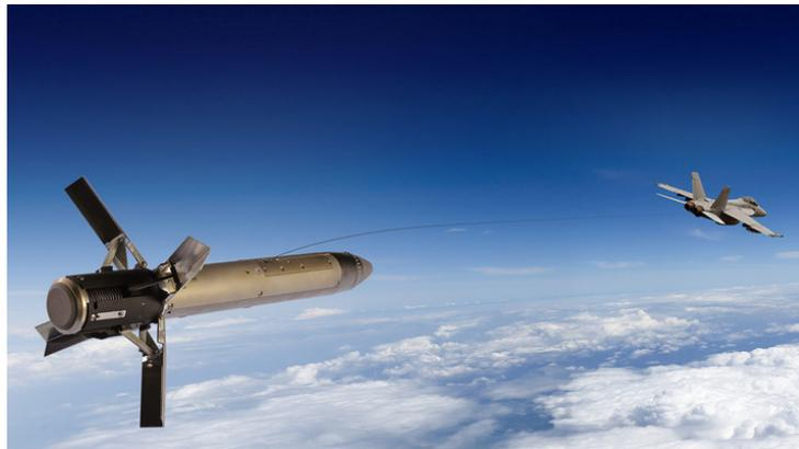
Figura 2.1: *Decoy* rebocado AN/ALE-55 empregado pela aeronave F/A-18E/F *Super Hornet*.
