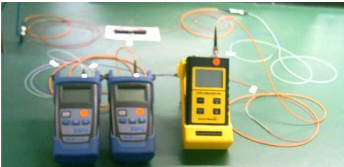
**Figura 6.6:** Conjunto de medidores de potência óptica “de mão” (*hand-held*) utilizados nos experimentos.
