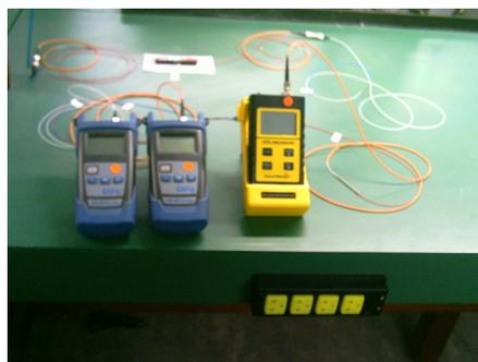
Fig. 2. Fotografia da configuração experimental da Figura 1. Pode-se notar o acoplador SM/MM (com *pigtails* em terminação FC) na parte superior da figura sobre um retângulo de papel branco.
