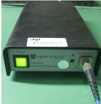
(a) Laser sintonizável na banda “C”.
