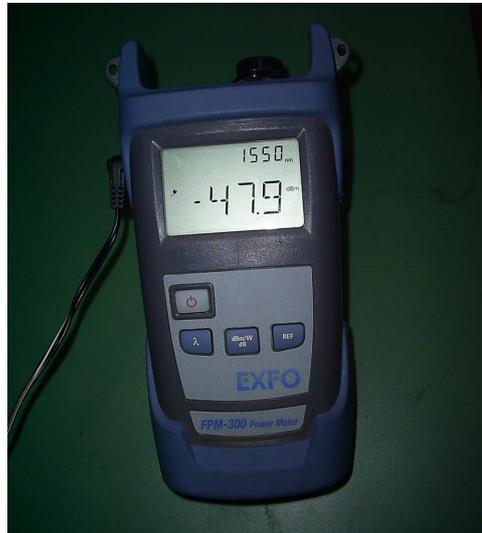
**Figura 3.4:** Medidor de potência óptica [FPM-300 Power Meter (EXFO)].
