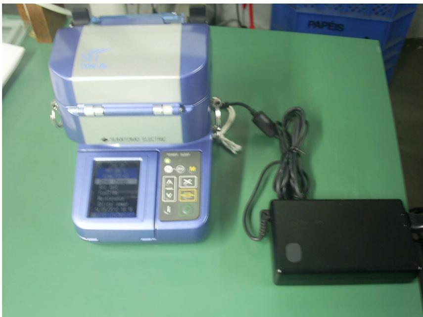
**Figura 3.6:** Máquina de emendas utilizada nas fusões, *SUMITOMO (25-S)*.
