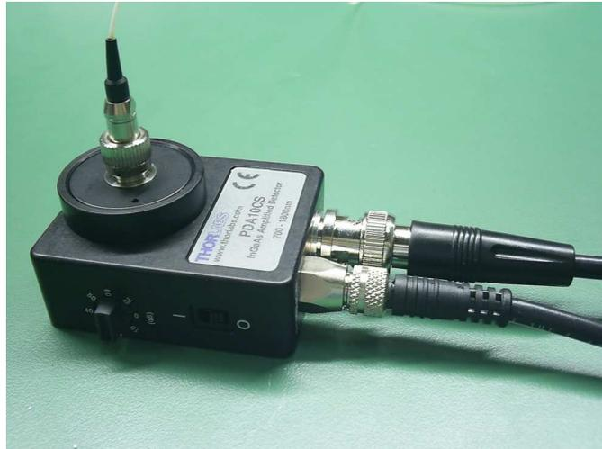
**Figura 4.4:** Receptor com amplificador de transimpedância embutido.
