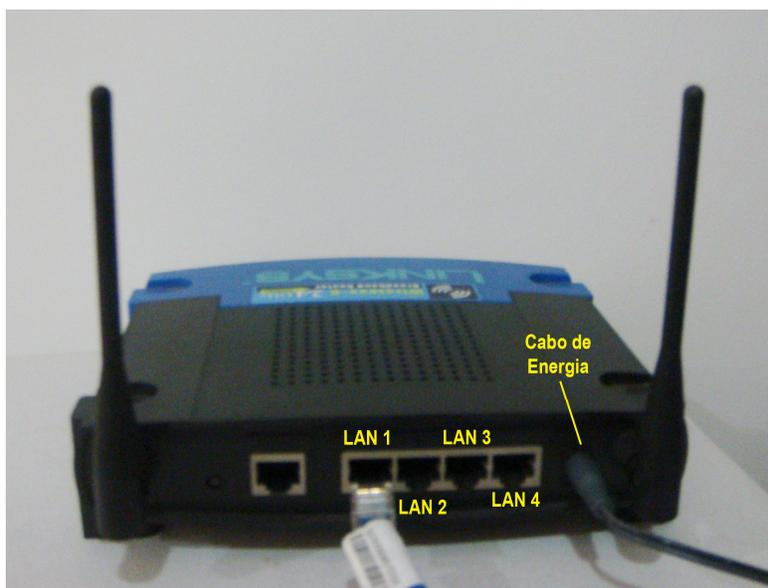
**Figura 56 - Como conectar o cabo de rede e o cabo de energia.**
