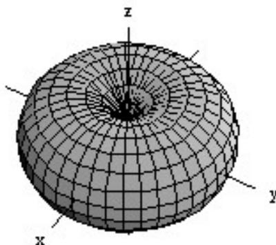
Figura 8. Diagrama de Irradiação de uma antena omnidirecional.
