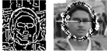
Figura 6.12: Detalhe da elipse selecionada na Figura 6.11: (a) Gradiente da região selecionada. (b) Gradientes utilizados para o cálculo da região de contorno definida pela elipse. Quanto mais próximos os gradientes utilizados neste cálculo indica que a elipse possivelmente define a região de contorno da face do interlocutor.
