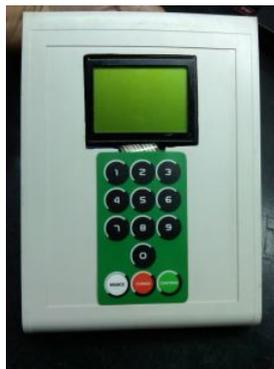
**Figura 3.9:** Equipamento de carga e recarga do cartão.
