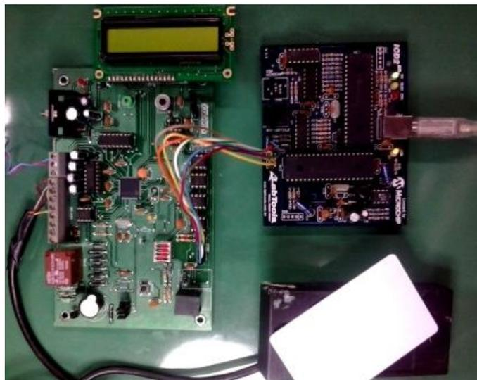
**Figura 4.6:** Placa do parquímetro.
