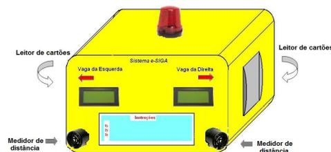
**Figura 3.6:** Parquímetro – Equipamento de Interface Com o Usuário.
