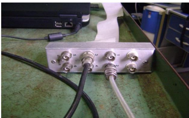
**Figura 23: Interface de aquisição dos sinais.**
