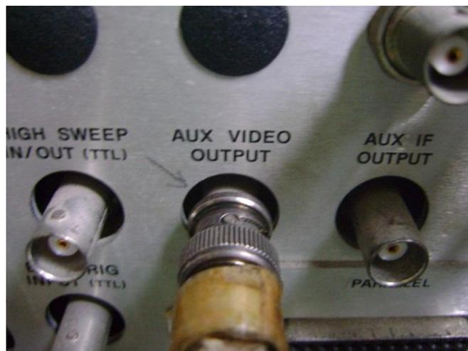
**Figura 17: Saída AUX VIDEO OUTPUT é ligada á placa de aquisição e esta é ligada ao computador.**
