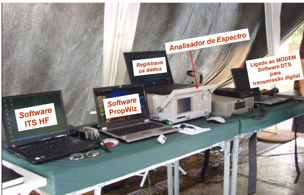
Figura 13 – Equipamentos utilizados
