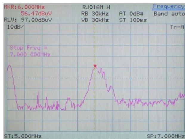
Figura 51 – Antena dipolo – medição do espectro de 5 a 7 MHz
