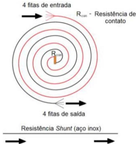
Figura 34: Arranjo da bobina do R-SFCL com *shunt* paralelo [8].
