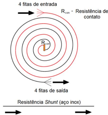
Figura 16: Arranjo da bobina de R-SFCL adaptada de [8].
