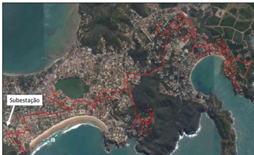
Figura 3.1. Alimentador da rede de Búzios. Fonte: Adaptado de [25]
