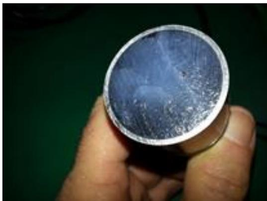
**Figura 19:** Transdutor com gel de acoplamento da superfície.
