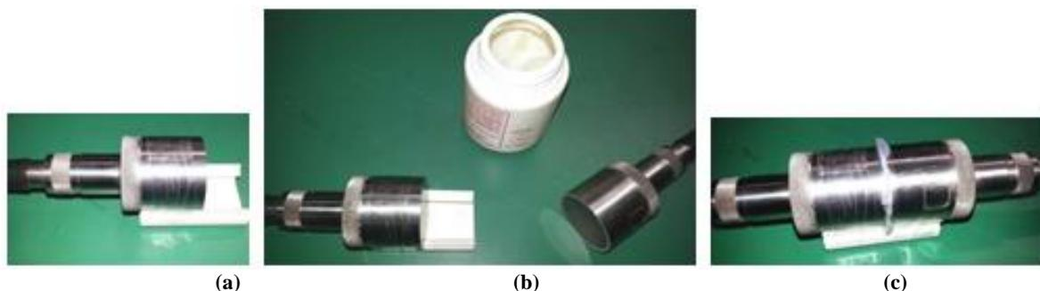
**Figura 27:** Sequência de operações para acoplamento back to back de dois transdutores.
