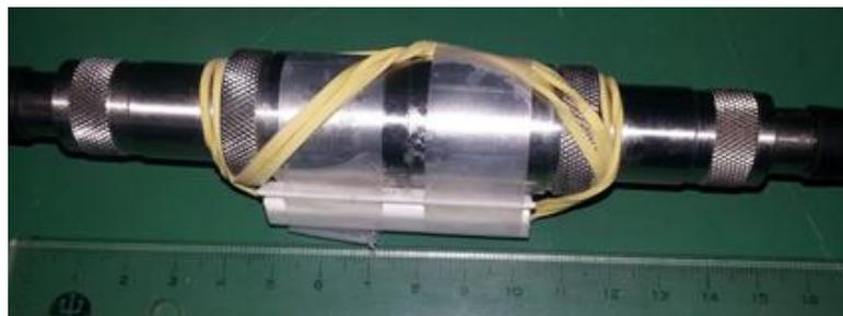
**Figura 26:** Dois transdutores mantidos alinhados por elos elásticos em uma guia e acoplados por gel.
