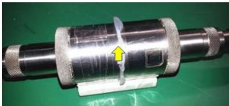
**Figura 18:** Montagem do acoplamento back-to-back de transdutores. A seta mostra o excesso de gel no acoplamento.
