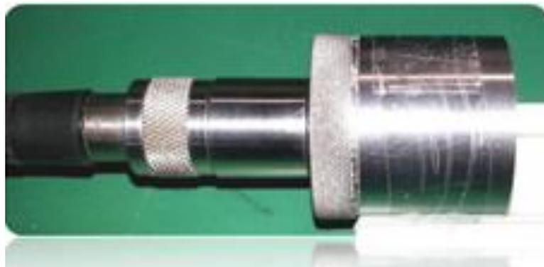
**Figura 25:** Transdutor Olympus a prova d'água.
