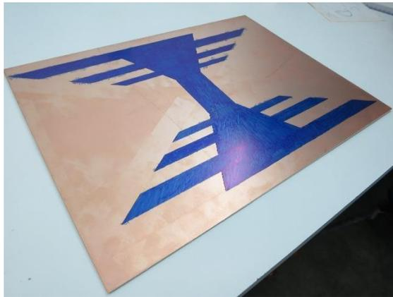
Figura 4.3: Área da antena protegida e pronta para corrosão.
