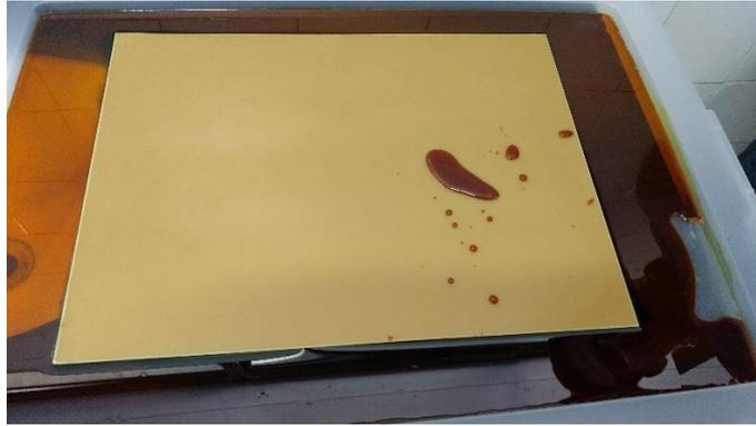
Figura 4.4: Placa durante o processo de corrosão.
