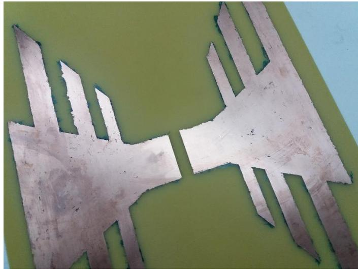
Figura 4.7: Corrosão entre os polos criando o *Port Gap*.
