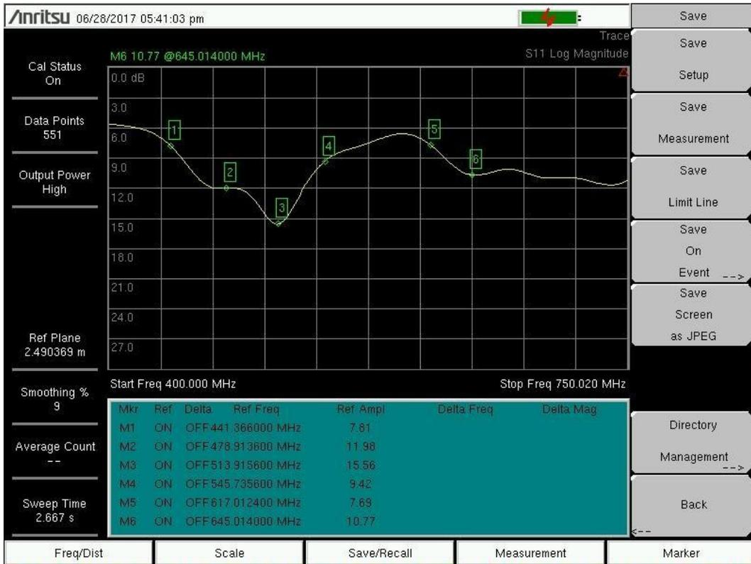
Figura 4.14: Perda de Retorno medido da Antena.
