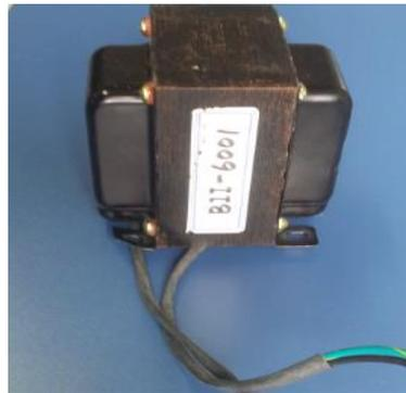
**Figura 61: Transformador de impedância BII-6000.**
