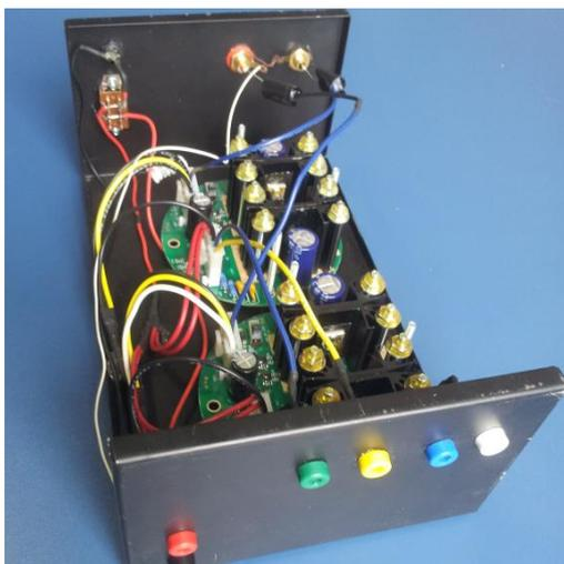
Figura 59: Amplificador de potência *Benthowave* BII-5002.
