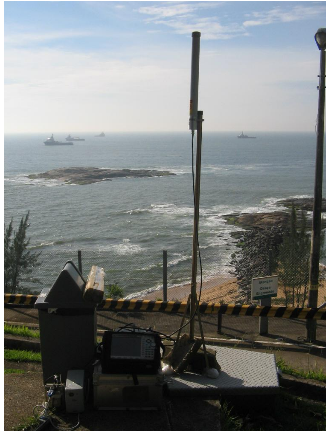
Figura 5.3 – Local do transmissor com gerador, amplificador de potência e antena
