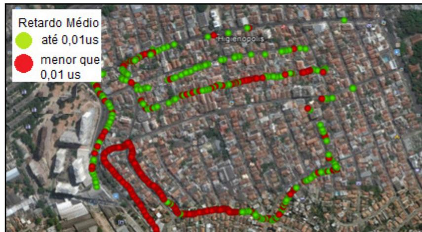
Fig. 63 - Mapeamento do retardo médio da antena esquerda no percurso.
